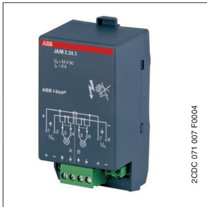
Das 2fach-Jalousieaktormodul ist ein Gerät zum Einschnappen in das Raum-Controller-Grundgerät. Es schaltet mit Relaiskontakten zwei unabhängige elektrische Antriebe, wie z.B. Jalousiemotoren oder Lüftungsklappenantriebe. Die Nenn-Schaltspannung beträgt 12 bzw. 24 V DC.
