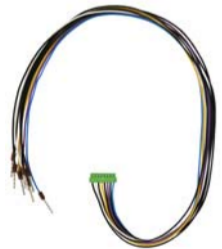
Abb. 8 Anschlussleitung für Analog/Digital-Eingänge: Eingang 1: schwarz (GND) / weiß Eingang 2: schwarz (GND) / gelb Eingang 3: schwarz (GND) / lila Eingang 4: schwarz (GND) / blau
