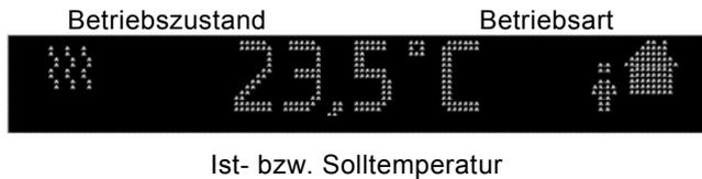
Das Display des Raumtemperaturreglers zeigt je nach Parametrierung entweder die aktuelle Raumtemperatur oder den Sollwert für die Temperatur an. Im linken Bereich des Displays wird der aktuelle Betriebszustand und im rechten Bereich die aktuelle Betriebsart angezeigt.
