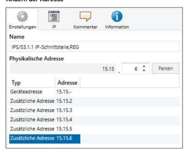
Zum Ändern der Adresse die aktuelle Geräteadresse bzw. zusätzliche Adresse markieren und mit den Pfeiltasten nach oben oder unten die gewünschte Ziffer auswählen. Durch Markieren einer anderen Adresse wird die geänderte Adresse gespeichert.
