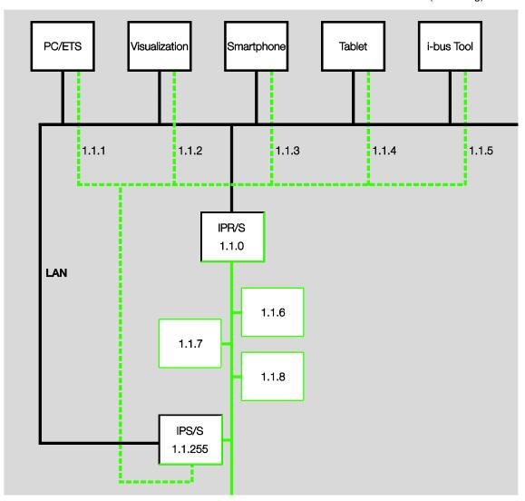
Die Schnittstelle verfügt über 5 Tunneling Server, siehe Kapitel Die Verwendung der integrierten Tunneling Server, S. 23. Diese unterstützen sowohl den Busmonitor- als auch den Gruppenmonitorbetrieb (alternativ).
