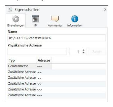
Im Eigenschaftsfenster Einstellungen kann der Gerätename eingetragen werden. Im Feld Name kann der Gerätename, der ins Gerät geladen wird, geändert werden.
