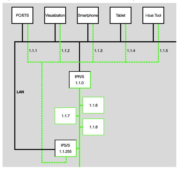
Bei Tunneling verbindet sich ein Client mit einer Buslinie. Das Tunneling-Verfahren verwendet UDP, beinhaltet aber eine Sicherungsschicht, so dass im Fehlerfall Telegramme wiederholt werden.
