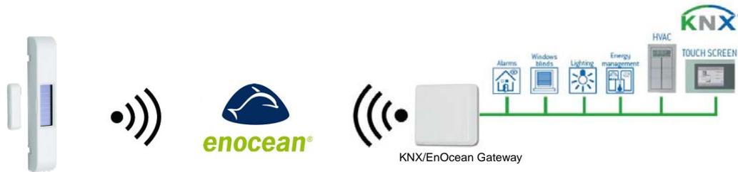
Abbildung 3.4 ABB KNX/EnOcean Gateway und Fensterkontakt Integrationsbeispiel
