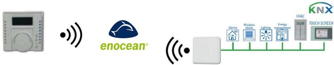
Abbildung 3.5 ABB KNX/EnOcean Gateway und Wippschalter Integrationsbeispiel
