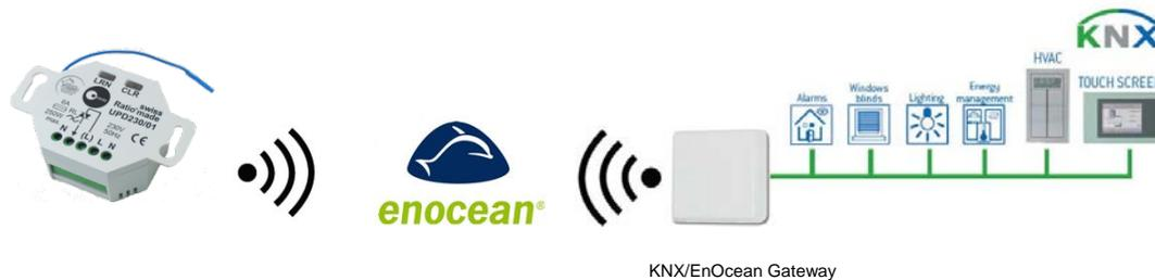
Abbildung 3.2 ABB KNX/EnOcean Gateway und Lichtaktor Integrationsbeispiel
