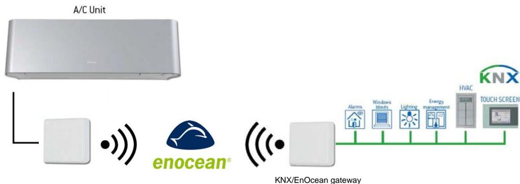
Abbildung 3.1 ABB KNX/EnOcean gateway und EnOcean Klimaanlage-Integrationsbeispiel
