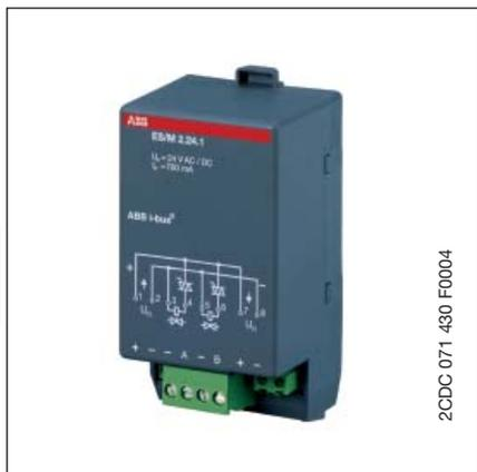
Das elektronische Schaltaktormodul 2-fach ist ein Gerät zum Einschnappen in das Raum-Controller-Grundgerät. Es schaltet mit zwei Halbleiterausgängen zwei ohmsche Verbraucher, wie z.B. elektrothermische Ventiltriebe zur Heizungssteuerung. Die Ausgänge sind geräuschlos und verschleißfrei. Die Nenn-Schaltspannung beträgt 12 bzw. 24 V.
