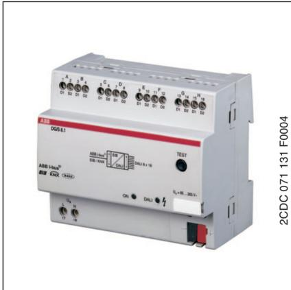
Das DALI-Gateway ist ein Reihen-einbaugerät zum Einbau im Verteiler auf einer Hutprofilschiene. Es dient der Ansteuerung von DALI-Betriebsgeräten z.B. Vorschaltgeräte, Transformatoren, Relais usw. über den EIB / KNX.
