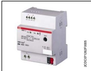
Das 1fach EIB / DALI Gateway DG/S 1.1 ist ein Reiheneinbaugerät im proM Design (4TE) für den Einbau in Verteiler auf einer 35 mm Tragschiene. Die Verbindung zum ABB i-bus® EIB / KNX erfolgt über Busanschlussklemme. Das DALI Gateway kann mit dem Anwendungsprogramm "Dimmen Slave Lichtszenen Dynamik 1f/x" Geräte mit DALI Schnittstelle in eine EIB / KNX Gebäudeinstallation einbinden.
