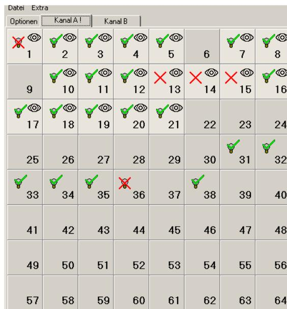
Diese Visualisierung zeigt in einer 8 x 8 Matrix die 64 Geräte mit DALI-Schnittstelle, die am Kanal A des DG/S 1.1 angeschlossen sind. Jeder Teilnehmer wird durch ein Lampensymbol angezeigt.
