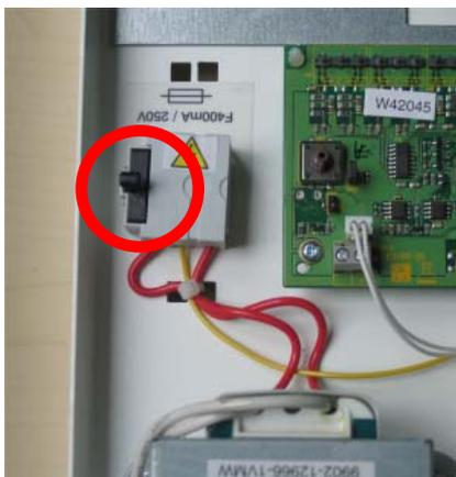
Trennen der 230 V durch Entfernen der Sicherung
