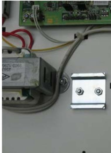
Mitgelieferte DIN-Schiene mit den selbstsichernden Muttern befestigen und die XS/S 1.1 aufsnappen.
