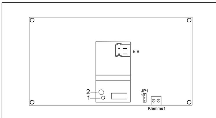
Stellungen JP1: keine Tastenverriegelung über Klemme1 möglich
