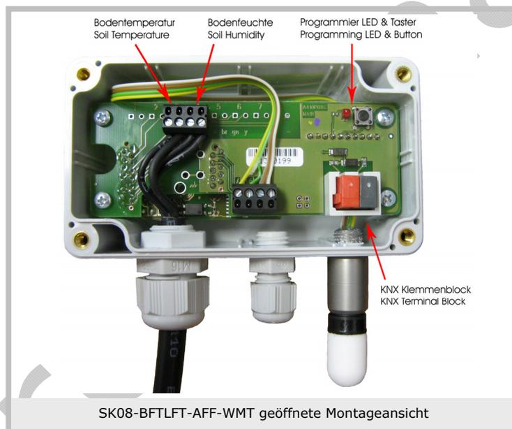
Der Deckel des Messumformers wird durch Drehen der Befestigungsschrauben gelöst.
