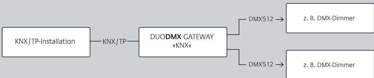
Das DUODMX GATEWAY 12021 ist mit dem KNX-Bus über Twisted Pair verbunden. Es erhält damit seine Steuerbefehle direkt über den KNX-Bus und leitet DMX-Pakete an die DMX-Dimmer weiter.
