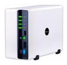
NAS (Network Attached Storage)-Laufwerk; Festplattenspeicher mit Netzwerkanbindung, z.B. für die Bereitstellung von Musikdateien für Squeezebox
