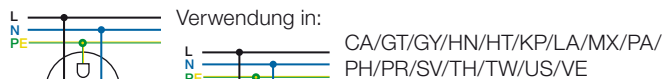
Bild 8: Steckdose mit Schutzkontakt USA/CANADA NEMA 5 – 15 R – 2-polig + Erde, 125 V~, 15 A (linke Abb.); 5 – 20 R – 2-polig + Erde, 125 V~, 20 A (rechte Abb.)
