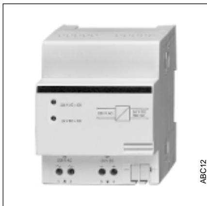
Das Netzteil ist ein Reiheneinbaugerät zum Einbau in Verteiler. es liefert eine geregelte Ausgangsspannung von 12 V DC mit einem maximalen Ausgangsstrom von 800 mA zur Hilfsspannungsversorgung in EIB-Anlagen oder anderen SELV-Applikationen.
