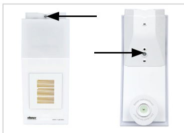
Abb. 16 Verschrauben Sie Deckel (oben) und Unterteil (unten).
