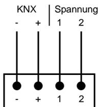
Die Anschlussdrähte arretieren sich von selbst, wenn sie in die Klemmen geschoben werden. Um einen Anschlussdraht leicht wieder entfernen zu können, drücken Sie die orange farbige Klemme und ziehen Sie den Draht heraus.
