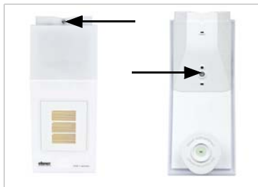
Abb. 16 Verschrauben Sie Deckel (oben) und Unterteil (unten).
