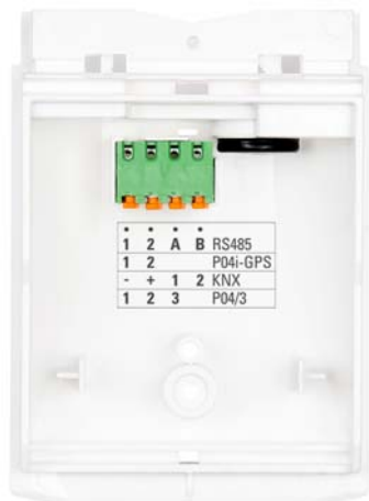
Abb. 14 Schließen Sie KNX-Daten (+/-) und Spannung (12...40 V DC, 12...28 V AC, 1|2) an der Anschlussklemme an.
