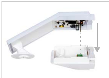
Abb. 15 Stecken Sie den Deckel auf das Unterteil. Dabei wird die Steckverbindung zwischen der Platine im Deckel und der Anschlussbuchse im Unterteil hergestellt.
