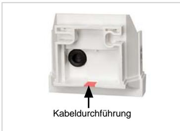
b) Wenn das Anschlusskabel aufputz verlegt ist, wird die Kabeldurchführung ausgebrochen. Das Kabel wird dann an der Gehäuseunterseite ins Gerät geführt.
