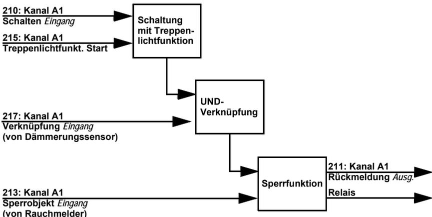
Beim Schalten über das Kommunikationsobjekt „Kanal A1 Schalten“ (210) wird das Licht normal ein- bzw. ausgeschaltet. Beim Schalten über das Objekt „Kanal A1 Trep-
