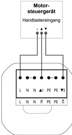
**Hinweis:** Die **Aktoren KNX S1R** sind durch den potenzialfreien Ausgang auch für den Einsatz mit Gleichspannung geeignet (12 V DC, 24 V DC). Der Anschluss „L“ wird in diesem Fall als „Com“ verwendet. Eine automatische Laufzeitermittlung durch Strommessung ist dann nicht möglich!
