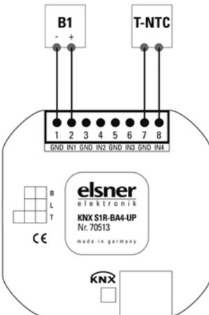
*Beispiel KNX S1R-BA4-UP mit Binärkontakt an Eingang 1 und Temperatursensor T-NTC an Eingang 4.*
