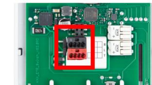
Wenn sich hinter dem Gerät ein Hohlraum befindet, z. B. bei Verwendung einer Dose, dann können Sie die rot-schwarze KNX-Busklemme zum Anschluss verwenden.
