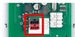
Si hay una cavidad detrás del dispositivo, como sucede cuando se usa una caja, puede usar el terminal de bus KNX rojo/negro para la conexión.
