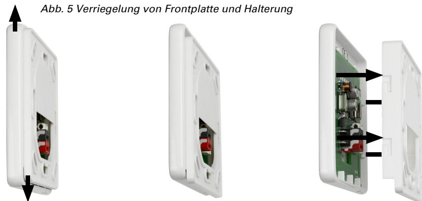
Abb. 5 Verriegelung von Frontplatte und Halterung
