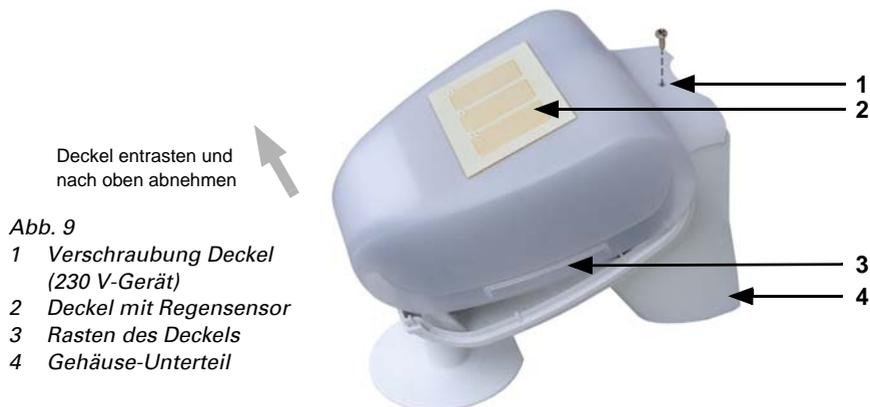
Der Deckel des Regen-/Windsensors ist am unteren Rand rechts und links eingerastet (siehe Abb.). Der Deckel des 230 V-Modells ist zusätzlich oben verschraubt. Nehmen Sie den Deckel ab. Gehen sie sorgfältig vor, um die Kabelverbindung zwischen der Platine im Unterteil und dem Regensensor im Deckel nicht abzureißen (beim 230 V AC-Modell gelötete Kabelverbindung, beim 24 V DC-Modell Kabel mit Stecker).
