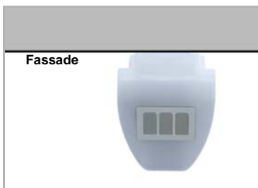
Abb. 4 Die Wetterstation muss in der Richtung der zu beschattenden Fassade ausgerichtet werden.
