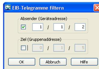
Abbildung 41: alle EIB-Telegramme eines Absenders filtern
