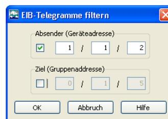
Abbildung 100: alle EIB-Telegramme eines Absenders filtern
