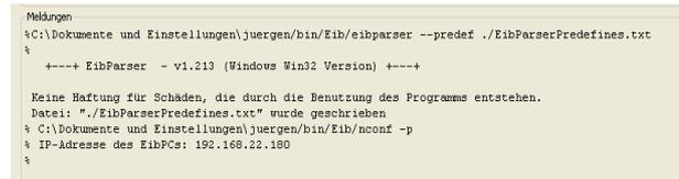
Abbildung 10: Meldungsfenster zeigt an, dass ein Enertex® EibPC gefunden wurde.
