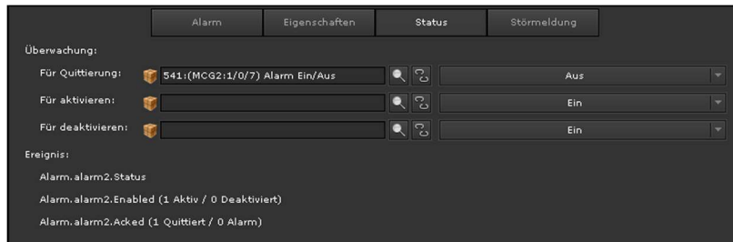
Abbildung 73: Statusprozesspunkte des Alarmzustands
