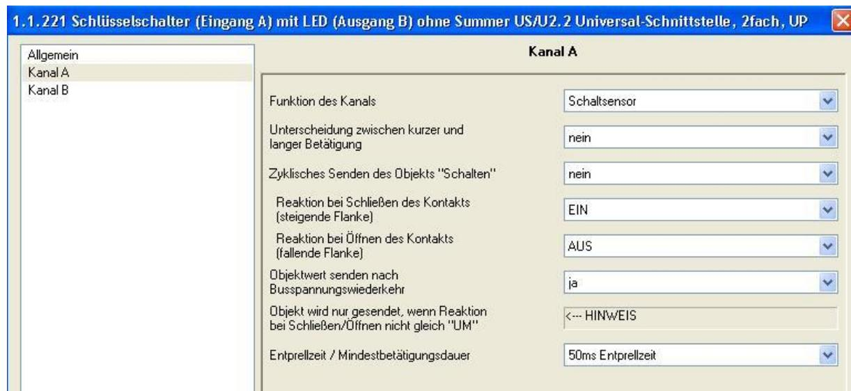
Abb. 6: Parameter für Schlüsselschalter (Kanal A)
