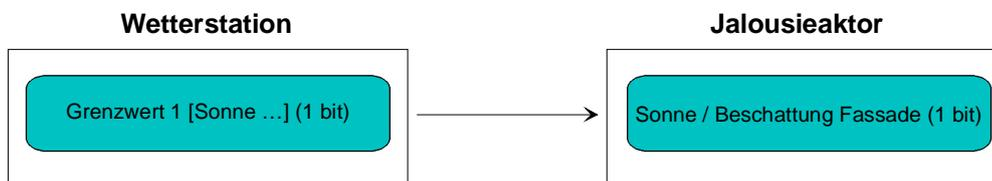
Bild 23: Projektierung der Kommunikationsobjekte für Anwendungsbeispiel I.
