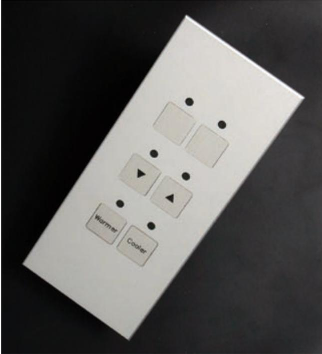
Die Tasten sind mit 12x12 mm sehr gut mit der Fingerspitze auch einer großen Hand zu bedienen. In der leicht erhabenen Bauform können die Tastenränder gut erfühlt werden.
