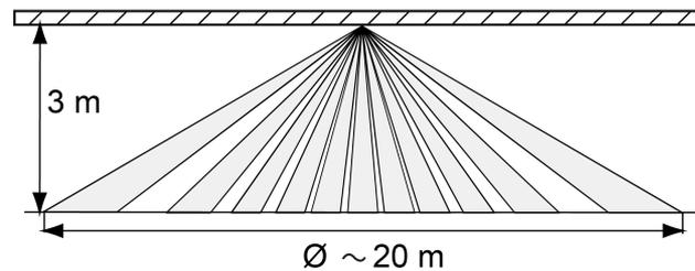
Bild 2: Durchmesser des Erfassungsbereichs bei Montagehöhe 3 m
