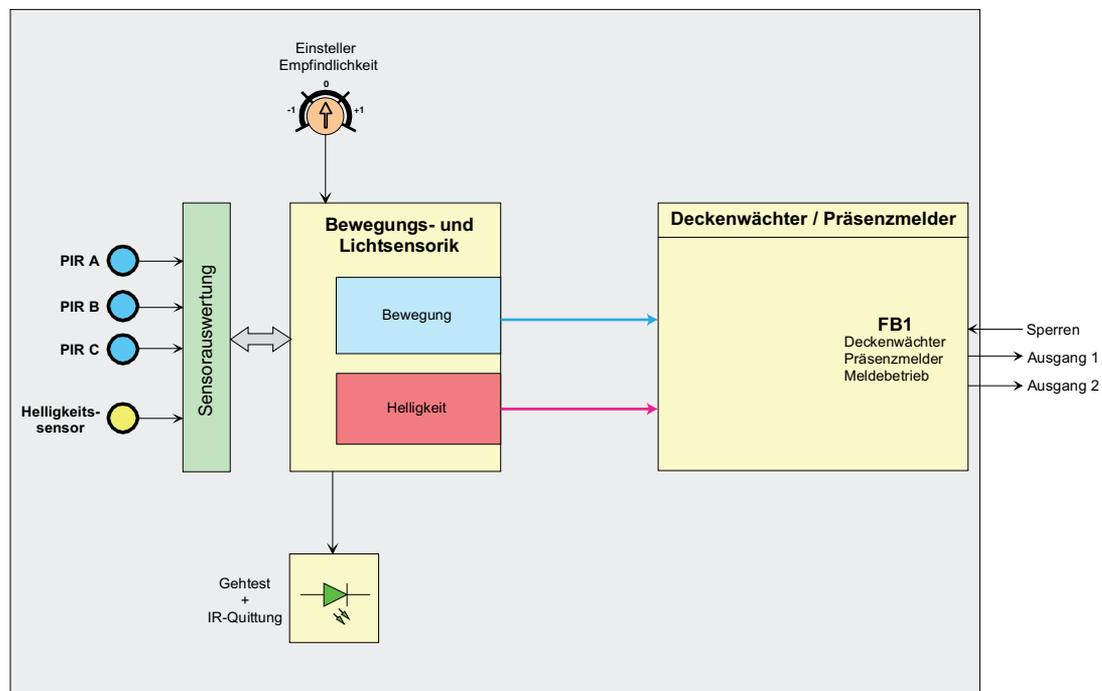
Bild 9: Blockschaltbild aller Funktionen des Geräts
