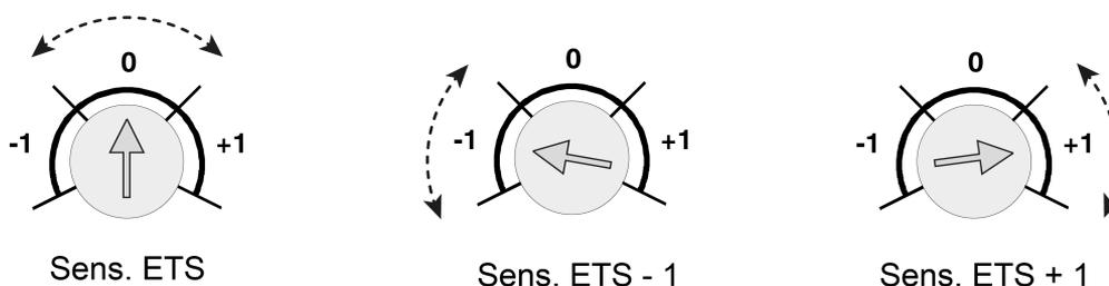
Bild 11: Einstellbereiche des Einstellers "Sens." am Gerät (-1 <-> 0 <-> +1)
