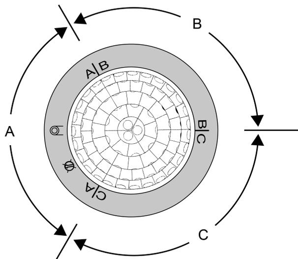
Bild 6: Anordnung der PIR-Sektoren A, B und C
