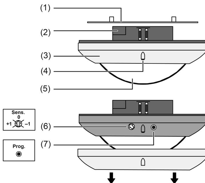
Bild 1: Geräteaufbau
