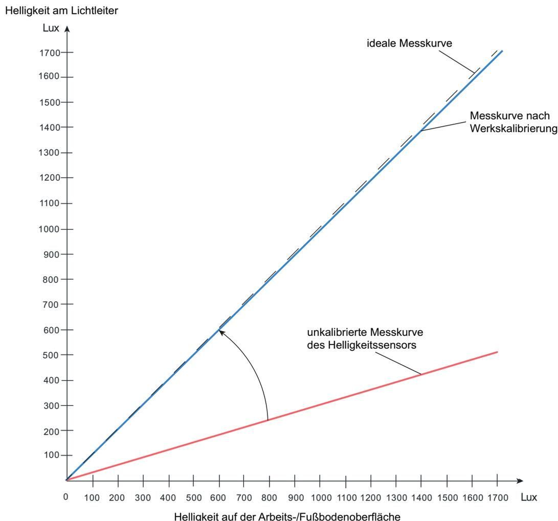
Bild 13: Bestimmung der Helligkeit an der Arbeits- / Fußbodenoberfläche bei Werkskalibrierung
