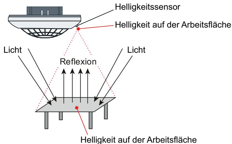
Bild 12: Helligkeitsermittlung durch Messung von reflektiertem Mischlicht aus Kunst- und Tageslichtanteil
