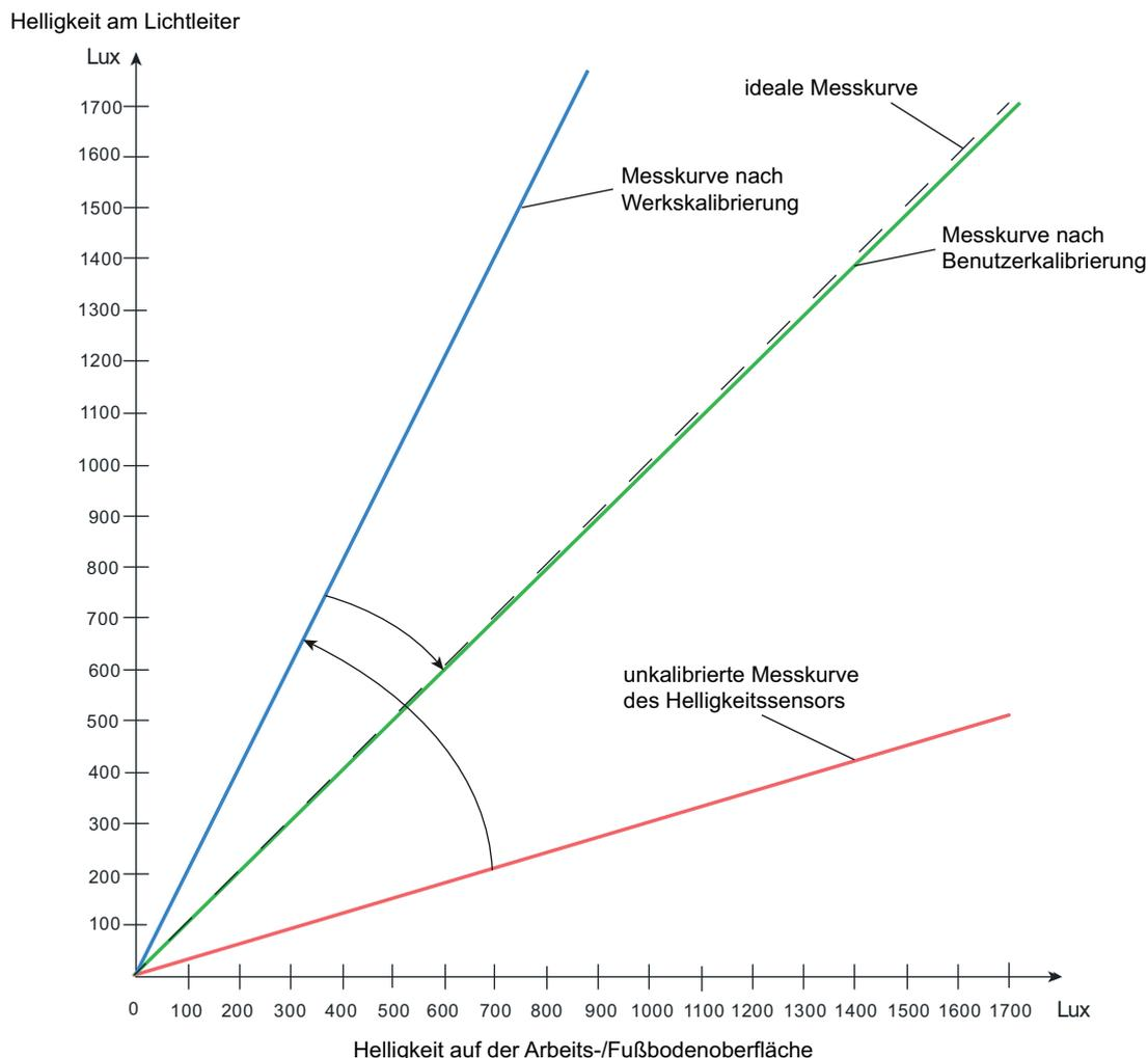
Bild 14: Korrektur der ermittelten Helligkeit an der Arbeits- / Fußbodenoberfläche durch Benutzerkalibrierung
