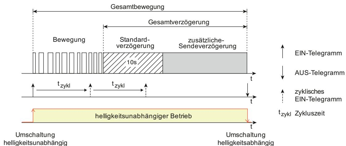
Bild 31: Gesamtbewegung mit Bewegungserfassung, Standardverzögerung und zusätzlicher Sendeverzögerung
