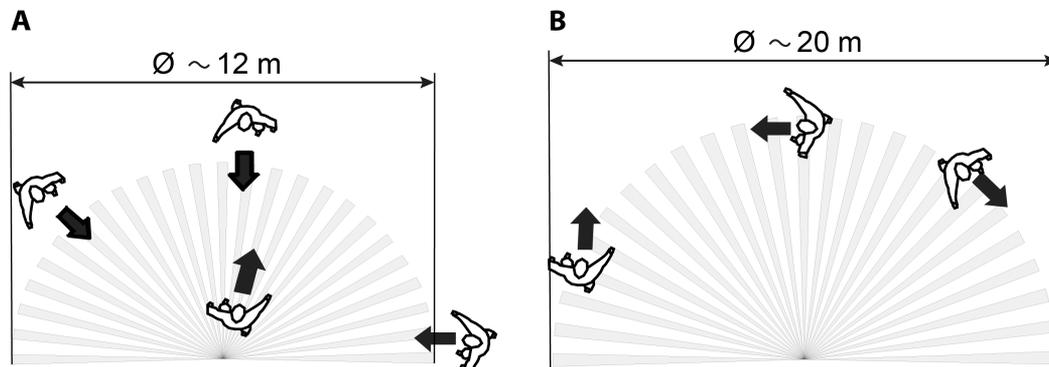
Bild 3: Erfassungreichweite in Abhängigkeit der Bewegungsrichtung bei Montagehöhe 3 m
