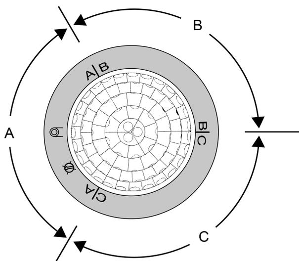
Bild 10: Anordnung der PIR-Sektoren A, B und C
