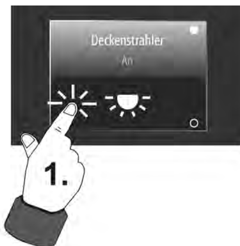
Bild 22: Beispiel für eine Direktbedienung (hier: Kanalfunktion "Schalten")
