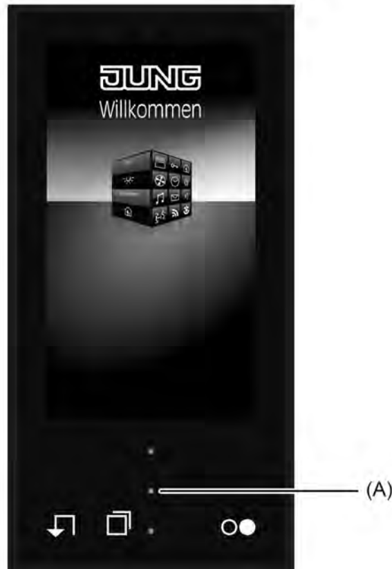
Bild 65: Helligkeitssensor an der Gerätefront
