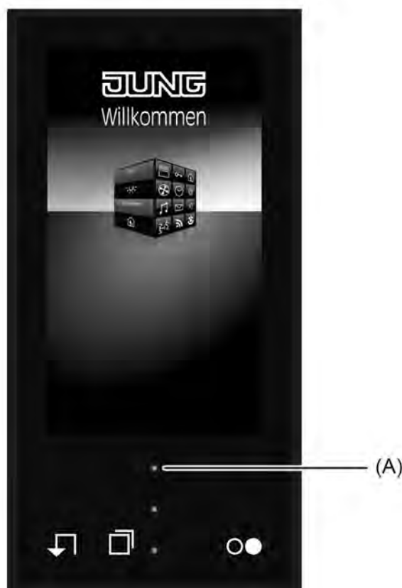
Bild 51: Betriebs-LED an der Gerätefront
