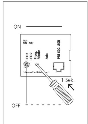
**6** Plug+Play-Mode am BNG/ BVNG 650-... durch kurzes Drücken der Taste Prog.-Mode ausschalten. LED 1 am BNG/BVNG 650-... blinkt jetzt wieder in der normalen Betriebsanzeige. Alle LEDs der Bus-Telefone sind aus, die Anlage ist betriebsbereit.
