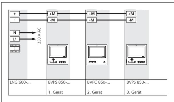
Es können maximal 3 BVPS/ BVPC 850-... mit einem Leistungs Netzgerät LNG 600-... versorgt werden. Der max. Strom der 30 V DC Gleichspannung des LNG 600-... beträgt 1100 mA. Diese Reichweiten gelten nur für die externe Versorgungsspannung der Geräte nicht für die Reichweiten des In-Home-Bus. Reichweiten gültig für J-Y(ST)Y oder YR Installationskabel mit 0,8 mm Aderdurchmesser! Aus einem Netzgerät dürfen nur Bus-Innengeräte versorgt werden, die sich im gleichen Strang befinden.
