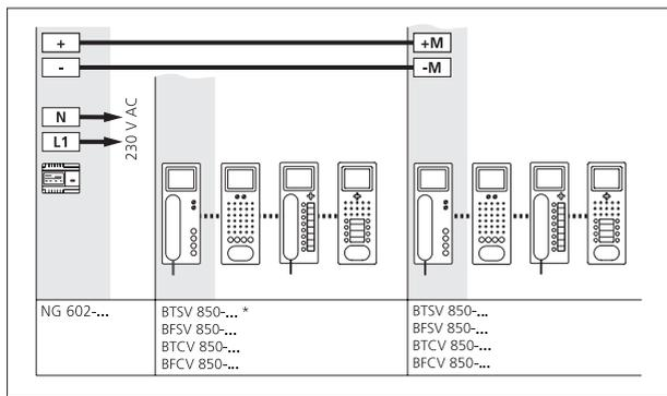
Es kann maximal 1 BTSV/BFSV/BTCV/BFCV 850-... mit einem Netzgerät NG 602-... versorgt werden. Der max. Strom der 24 V DC Gleichspannung des NG 602-... beträgt 300 mA. Sollen mehrere Bus-Telefone gleichzeitig über eine Klingeltaste klingeln, muss jedes BTSV/BFSV/BTCV/BFCV 850-... ein eigenes NG 602-... haben. Alternativ können bis zu 3 Bus-Telefone mit Farbmonitor von einem Video-Netzgerät VNG 602-... versorgt werden.
