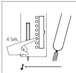
**5** Am Bus-Telefon die gewünschte Taste für 4 Sekunden gedrückt halten, mit welcher die externe Kamera angewählt werden soll. Am Bus-Telefon Hörer auflegen. Die Taste ist jetzt der externen Kamera zugeordnet. Die externe Kamera kann jederzeit angewählt werden.
