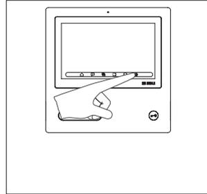
**3** Tippen Sie auf Einstellungen; > Installation; > Programmierung starten; > Start. Das Bus-Video-Panel Comfort baut die Sprechverbindung zur Türstation auf. Das Bus-Video-Panel Comfort ist jetzt im Programmiermodus.
