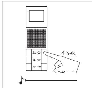
**5 Video-Innenstation 1:** Internruftaste für 4 Sekunden gedrückt halten, mit dem das zweite Gerät gerufen werden soll. Ein langgezogener Ton ist zu hören.
