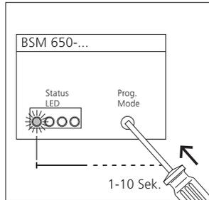
**5** Die Schaltzeit des Kontaktes wird bestimmt durch die Zeit, wie lange der Schraubendreher gedrückt wird.
