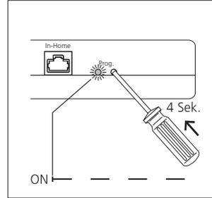
**3** Prog.-Taste an der Basisstation für 4 Sekunden drücken. Danach blinkt die LED Prog. im Sekunden-Rhythmus. Das Siedle Scope/ Smart Gateway Mini ist jetzt im Programmiermodus.
