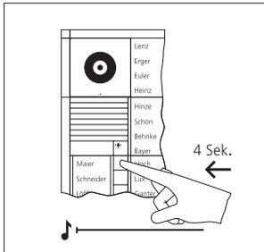
**4** An der Türstation die gewünschte Rufmelodie-Taste für 4 Sekunden gedrückt halten, bis am Türlautsprecher ein langgezogener Ton zu hören ist. Die Rufmelodie ist jetzt dem Bus-Innengerät zugeordnet, die Sprechverbindung besteht nicht mehr.
