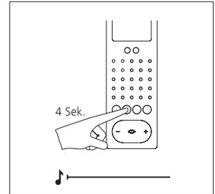
**3** Lichttaste für 4 Sekunden gedrückt halten. Die Etagenrufmelodie ertönt und die Taste Stummschaltung blinkt. Es besteht Sprechverbindung zur Türstation. Das Bus-Freisprechelefon ist jetzt im Programmiermodus.
