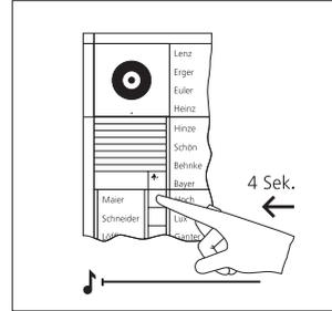
**3** An der Türstation die Ruftaste drücken die dem BSE 650-... zugeordnet werden soll. Die Zuordnung zu einem- oder mehreren Bus-Telefonen muss vorhanden sein.
