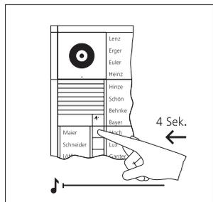
**4** An der Türstation die gewünschte Ruf Taste für 4 Sekunden gedrückt halten, bis am Türlautsprecher ein langgezogener Ton zu hören ist. Die Ruf Taste ist jetzt dem Bus-Innengerät zugeordnet, die Sprechverbindung besteht nicht mehr.
