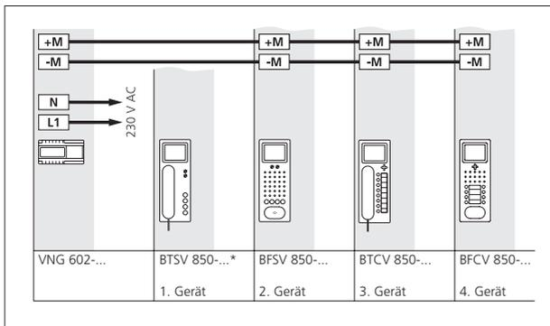
Es können maximal 3 BTSV/BFSV/ BTCV/BFCV 850-... mit einem Video-Netzgerät VNG 602-... versorgt werden. Der max. Strom der 30 V DC Gleichspannung des VNG 602-... beträgt 1100 mA. Diese Reichweiten gelten nur für die externe Versorgungsspannung der Geräte nicht für die Reichweiten des In-Home-Bus. Reichweiten gültig für J-Y(ST)Y oder YR Installationskabel mit 0,8 mm Aderdurchmesser! Aus einem Netzgerät dürfen nur Bus-Innengeräte versorgt werden, die sich im gleichen Strang befinden.
