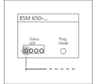
**3** Das entsprechende Relais auswählen, dazu mit dem Schraubendreher die Taste Prog.-Mode am BSM 650-... betätigen, bis gewünschte LED leuchtet (LED 1 = Relais 1).
