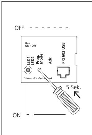
**1** Plug+Play-Mode am BNG/ BVNG 650-... aktivieren, Prog.-Mode Taste 5 Sekunden gedrückt halten, LED 1 leuchtet auf Daueranzeige.
