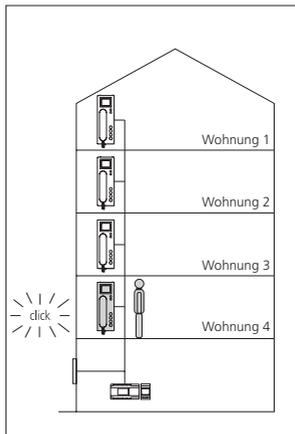
**5** Bus-Telefon in Wohnung 4 mit aufgelegtem Hörer aufsetzen, Etagenruf ist zu hören und die LED der Taste Stummschaltung blinkt.
