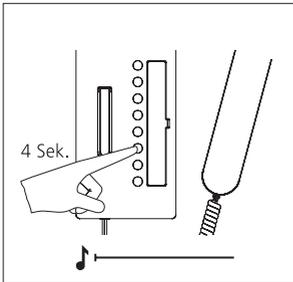
**4** Die Taste drücken, die programmiert werden soll, für 4 Sekunden gedrückt halten. Im Hörer ist ein langgezogener Quittungston zu hören. Der Schaltkontakt des BSE 650-... wird für 1 Sekunde geschlossen.
