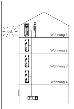
**2** Bus-Telefon in Wohnung 1 mit aufgelegtem Hörer aufsetzen, Etagenruf ist als Quittierung zu hören und die LED der Taste Stummschaltung blinkt. Das Bus-Telefon 1 ist der Taste 1 zugeordnet.
