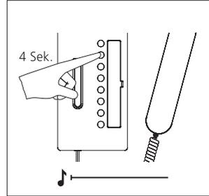
**3** Am Bus-Telefon das programmiert werden soll, Hörer abnehmen. Lichttaste für 4 Sekunden gedrückt halten. Im Hörer ist ein langgezogener Quittungston zu hören – die Taste Stummenschaltung blinkt. Es besteht Sprechverbindung zur Türstation. Das Bus-Telefon ist jetzt im Programmiermodus. Hörer nicht auflegen.
