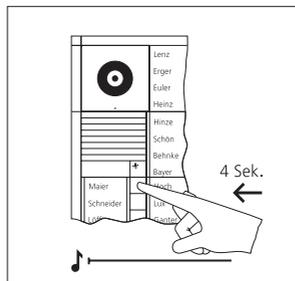
**5** An der Türstation die gewünschte Ruf Taste für 4 Sekunden gedrückt halten, bis am Türlautsprecher ein langgezogener Ton zu hören ist. Die Ruf Taste ist jetzt dem Bus-Innengerät zugeordnet, die Sprechverbindung besteht nicht mehr.
