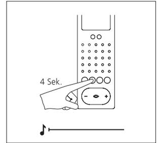
**3** Lichttaste für 4 Sekunden gedrückt halten. Die Etagenrufmelodie ertönt und die Taste Stummschaltung blinkt. Es besteht Sprechverbindung zur Türstation. Das Bus-Freisprechtelefon ist jetzt im Programmiermodus.
