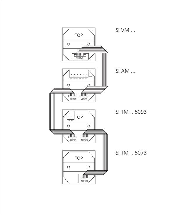
Jedes Modul wird in eine Unterputz-Geräteverbindungsdose nach DIN 49073 eingebaut. Der Einbau in eine tiefe Dose wird empfohlen. Die Montage erfolgt mit den beiliegenden Tragringen.
