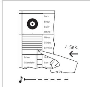
**2** An der Türstation die Licht-/Programmier Taste 4 Sekunden gedrückt halten. Danach ist ein langgezogener Quittungston zu hören, der alle 5 Sekunden kurz wiederholt wird, solange der Programmiermodus aktiv ist.
