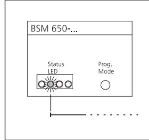
**3** Das entsprechende Relais auswählen, dazu mit dem Schraubendreher die Taste Prog.-Mode am BSM 650-... betätigen, bis gewünschte LED leuchtet, (LED2 = Relais 2, 2x drücken).
