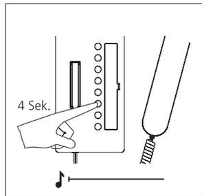
**5** Am Bus-Telefon die gewünschte Taste für 4 Sekunden gedrückt halten, mit welcher die Türstation angewählt werden soll. Hörer auflegen. Die Taste ist jetzt der Türstation zugeordnet. Der Türlautsprecher kann jederzeit angewählt werden.
