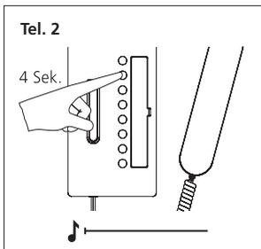
**4** Am zweiten Bus-Telefon das programmiert werden soll, Hörer abnehmen. Lichttaste für 4 Sekunden gedrückt halten. Hörer nicht auflegen! Bei allen weiteren Bus-Telefonen gleiche Vorgehensweise.
