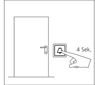
**3** Die am Bus-Innengerät angeschlossene Etagenruftaste für 4 Sekunden gedrückt halten. Das Bus-Innengerät ist jetzt im Programmiermodus. Während dieser Zeit darf innerhalb der Anlage nicht geklingelt werden!
