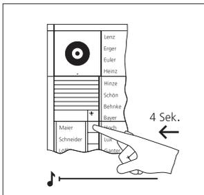
**4** An der Türstation die gewünschte Rufnummer für 4 Sekunden gedrückt halten, bis am Türlautsprecher ein langgezogener Ton zu hören ist. Die Rufnummer ist jetzt dem Bus-Innengerät zugeordnet, die Sprechverbindung besteht nicht mehr.
