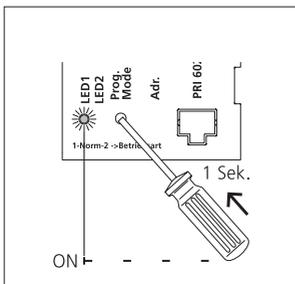
Mit einem kleinen Schraubendreher durch die Öffnung in der Abdeckung das Bus-Netzgerät in den Programmiermodus setzen.
