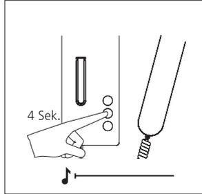
1.1 Lichttaste für 4 Sekunden drücken. Als Bestätigung ist im Hörer ein langgezogener Quittungston zu hören. Das Bus-Telefon ist jetzt im Programmiermodus – die Taste Stummschaltung blinkt. Den Hörer erst wieder auflegen, nachdem am Bus-Telefon die Programmierung abgeschlossen wurde.
