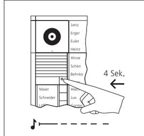
**2** An der Türstation die Licht-/ Programmertaste 4 Sekunden gedrückt halten. Danach ist ein langgezogener Quittungston zu hören, der alle 5 Sekunden kurz wiederholt wird, solange der Programmiermodus aktiv ist.
