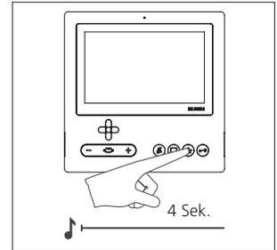
**3** Lichttaste für 4 Sekunden drücken. Als Bestätigung ist ein langgezogener Quittungston zu hören und die Taste Stummschaltung beginnt zu blinken. Das Bus-Video-Panel Standard baut die Sprechverbindung zur Türstation auf. Das Bus-Video-Panel Standard ist jetzt im Programmiermodus.
