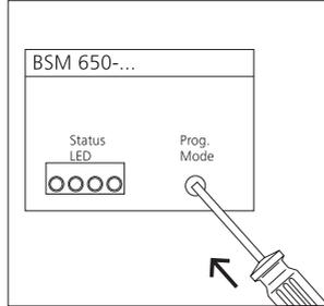
**2** Das BSM 650-... in den Programmiermodus schalten. Dazu mit einem kleinen Schraubendreher die Prog.-Mode-Taste kurz drücken. LED 1 leuchtet und blinkt nach ca. 3 Sekunden langsam.
