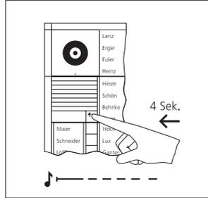
**2** An der Türstation die Licht-/Programmirtaste 4 Sekunden gedrückt halten. Danach ist ein langgezogener Quittungston zu hören, der alle 5 Sekunden kurz wiederholt wird, solange der Programmiermodus aktiv ist.
