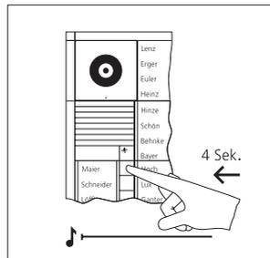
**5** An der Türstation die gewünschte Rufnummer für 4 Sekunden gedrückt halten, bis am Türlautsprecher ein langgezogener Ton zu hören ist. Die Rufnummer ist jetzt dem Bus-Innengerät zugeordnet, die Sprechverbindung besteht nicht mehr.
