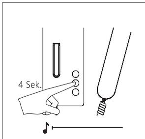
**4** Lichttaste für 4 Sekunden gedrückt halten. Im Hörer ist ein langgezogener Quittungston zu hören – die Taste Stummschaltung blinkt. Es besteht Sprechverbindung zur Türstation. Das Bus-Telefon ist jetzt im Programmiermodus. Hörer nicht auflegen.
