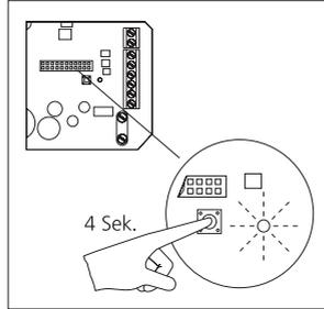
**2** Am BVA 650-... die Programmier-taste 4 Sekunden gedrückt halten. Danach blinkt die Status-LED in kurzen Abständen, solange Programmiermodus aktiv ist.
