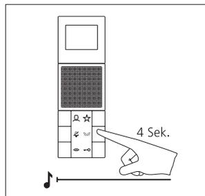
**3** Lichttaste für 4 Sekunden drücken. Als Bestätigung ist ein langgezogener Quittungston zu hören und die Taste Stummschaltung beginnt zu blinken. Die Video-Innenstation baut die Sprechverbindung zur Türstation auf. Die Video-Innenstation ist jetzt im Programmiermodus.
