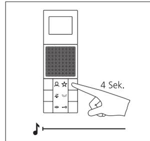
**6 Video-Innenstation 2:** Internruftaste, mit dem das erste Gerät gerufen werden soll, für 4 Sekunden drücken. Ein langgezogener Ton ist zu hören. Die Tasten sind jetzt an beiden Geräten programmiert.
