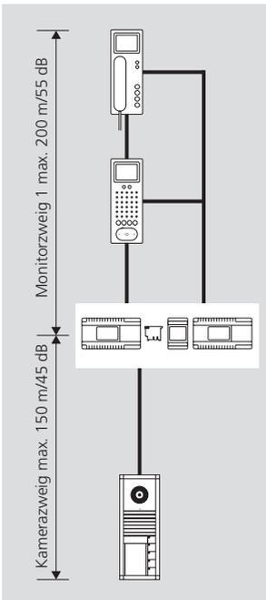
**Installation mit J-Y(St)Y, Erhöhte Reichweite**
