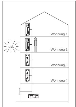
**3** Bus-Telefon in Wohnung 2 mit aufgelegtem Hörer aufsetzen, Etagenruf ist zu hören und die LED der Taste Stummschaltung blinkt.
