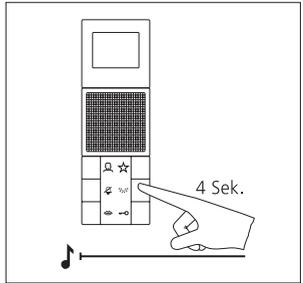
**3 Video-Innenstation 1:** Lichttaste für 4 Sekunden drücken. Als Bestätigung ist ein langgezogener Quittungston zu hören und die Taste Stummschaltung beginnt zu blinken. Die Video-Innenstation baut die Sprechverbindung zur Türstation auf. Die Video-Innenstation ist jetzt im Programmiermodus.
