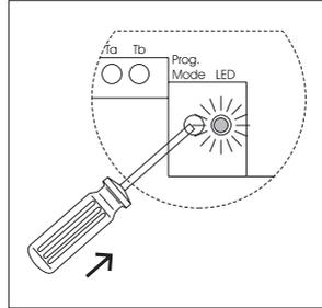
**2** Die BSE 650-... in den Programmiermodus schalten. Dazu mit einem kleinen Schraubendreher die Prog.-Mode-Taste drücken. LED blinkt langsam.
