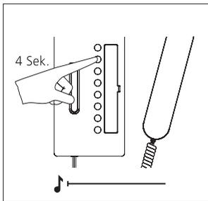
**4** Lichttaste für 4 Sekunden gedrückt halten. Im Hörer ist ein langgezogener Signalton zu hören. Das Bus-Telefon ist jetzt im Programmiermodus. Hörer nicht auflegen. Das Bild der Kamera ist auf dem Monitor zu sehen.
