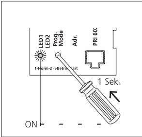
**1** Programmiermodus einschalten. Am BNG/BVNG 650-... die Taste Prog.-Mode kurz drücken. Die LED 1 blinkt im 2-Sekunden-Rhythmus für die Anzeige, dass der Programmiermodus aktiv ist.
