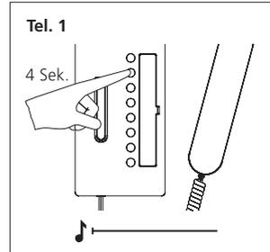
**3** Am ersten Bus-Telefon das programmiert werden soll, Hörer abnehmen. Lichttaste für 4 Sekunden gedrückt halten. Im Hörer ist ein langgezogener Signalton zu hören. Es besteht Sprechverbindung zur Türstation. Das Bus-Telefon ist jetzt im Programmiermodus. Hörer nicht auflegen!
