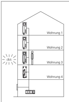
**4** Bus-Telefon in Wohnung 3 mit aufgelegtem Hörer aufsetzen, Etagenruf ist zu hören und die LED der Taste Stummschaltung blinkt.
