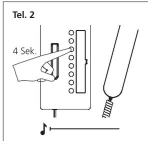
**8** Am zweiten Bus-Telefon die Internruftaste, mit dem das erste Bus-Telefon gerufen werden soll, für 4 Sekunden drücken. Ein langgezogener Ton ist zu hören. Die Tasten sind jetzt an beiden Bus-Telefonen programmiert.
