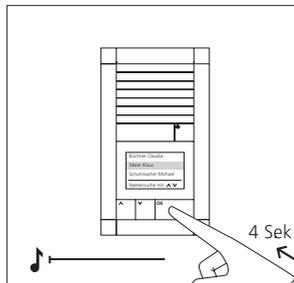
**5** Wenn der ausgewählte Name im Display steht, die OK-Taste auf dem DRM 612-... für 4 Sekunden gedrückt halten, bis am Türlautsprecher ein langgezogener Ton zu hören ist. Der ausgewählte Name ist jetzt dem Bus-Telefon zugeordnet. Die Sprechverbindung ist unterbrochen. War der Name bereits programmiert, muss die OK-Taste 2x gedrückt werden.
