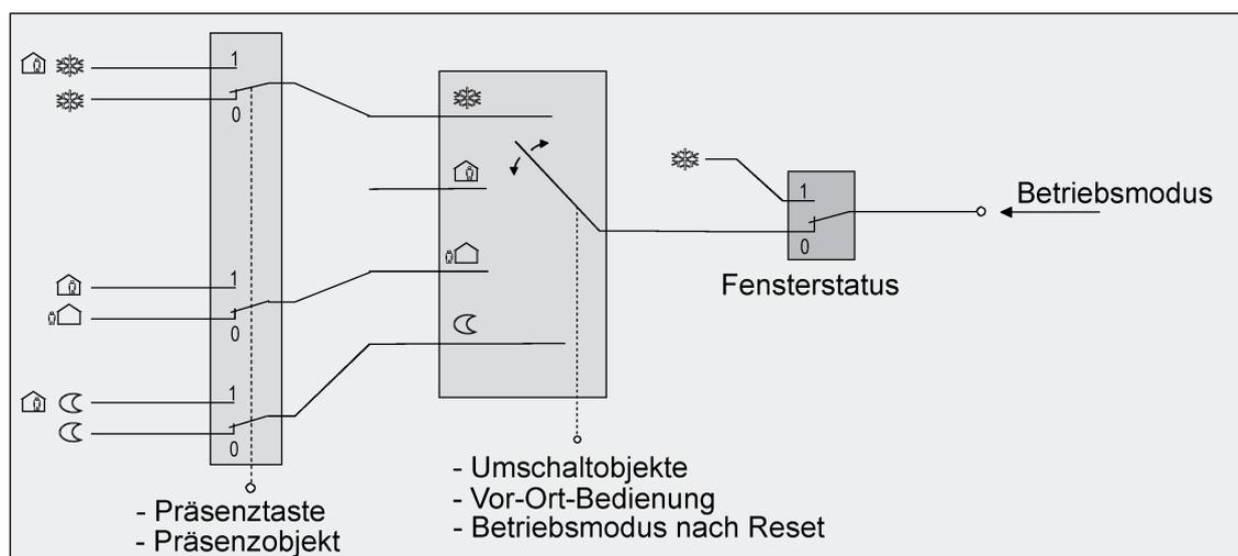
Bild 51: Betriebsmodusumschaltung durch 4 x 1 Bit Objekte mit Präsenztaste
