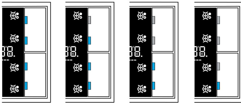
Bild 72: Standard Anzeigefunktion: negative Sollwertverschiebung "4 Schritte"
