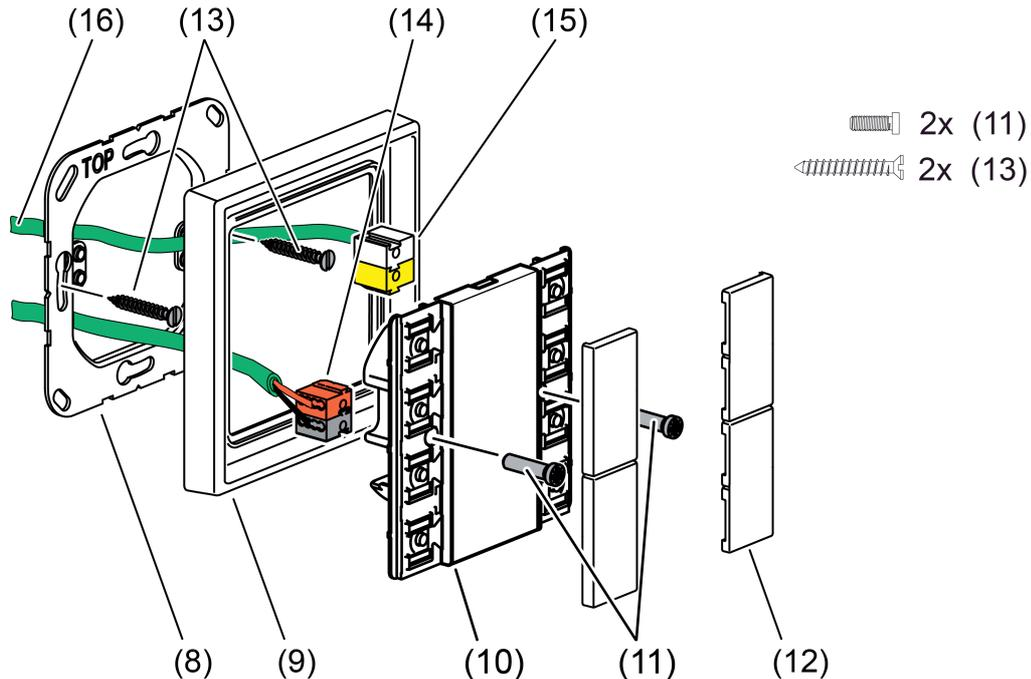
Bild 8: Montage des Kompakt-Raumcontroller-Moduls mit Anschluss eines Erweiterungsmoduls
