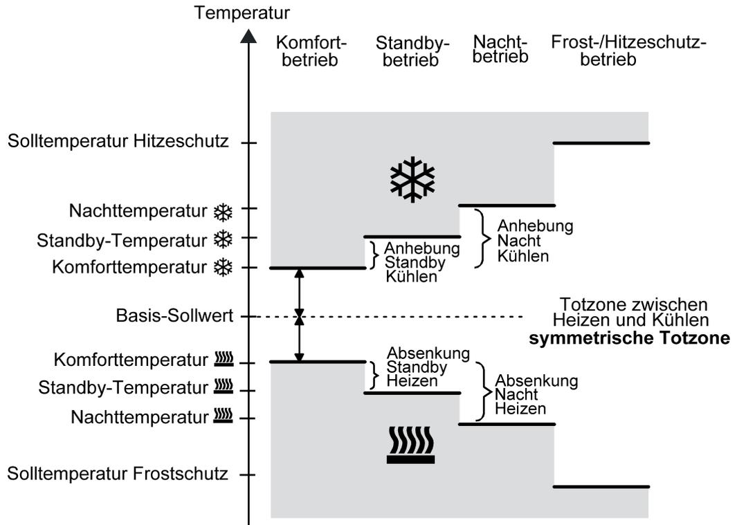
Bild 59: Solltemperaturen in der Betriebsart "Heizen und Kühlen" mit symmetrischer Totzone
