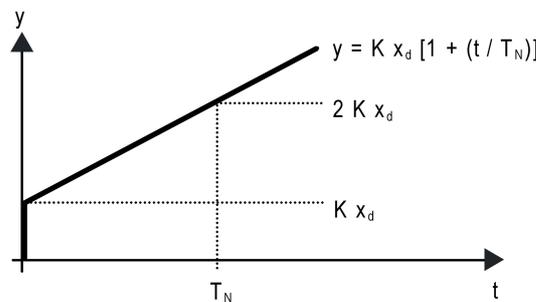
Bild 49: Funktion der Stellgröße einer PI-Regelung
