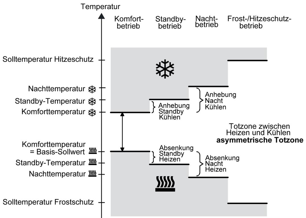
Bild 60: Solltemperaturen in der Betriebsart "Heizen und Kühlen" mit asymmetrischer Totzone
