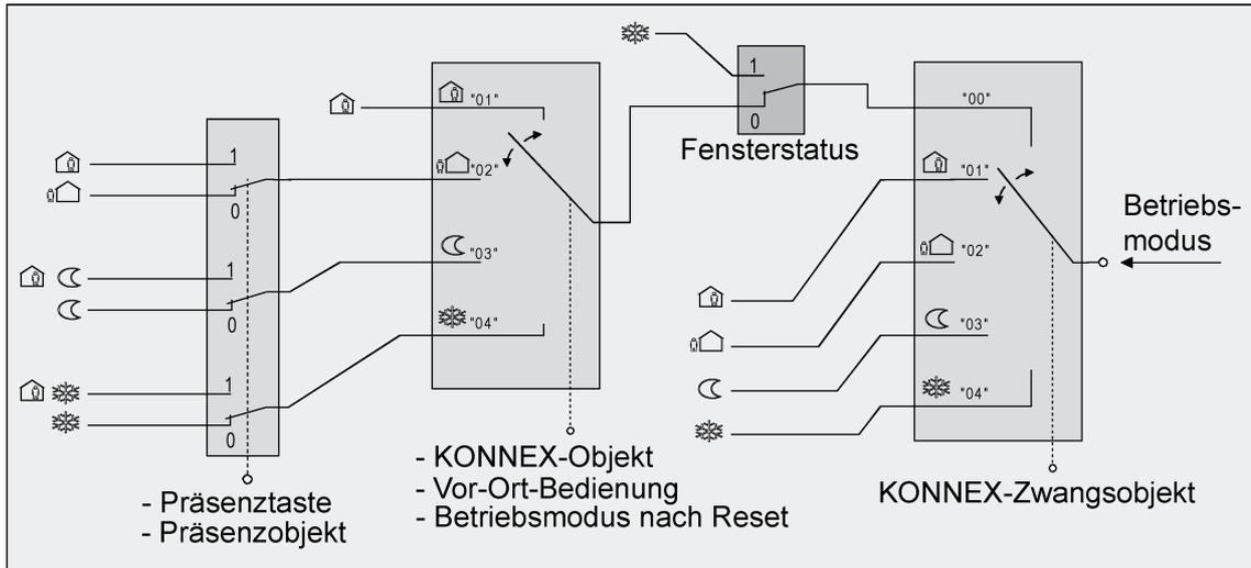
Bild 53: Betriebsmodusumschaltung durch KONNEX Objekt mit Präsenztaste
