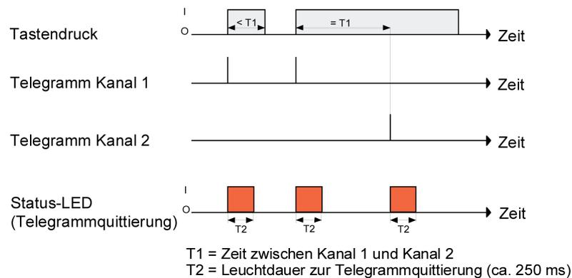
Bild 71: Beispiel zum Bedienkonzept "Kanal 1 oder Kanal 2"
