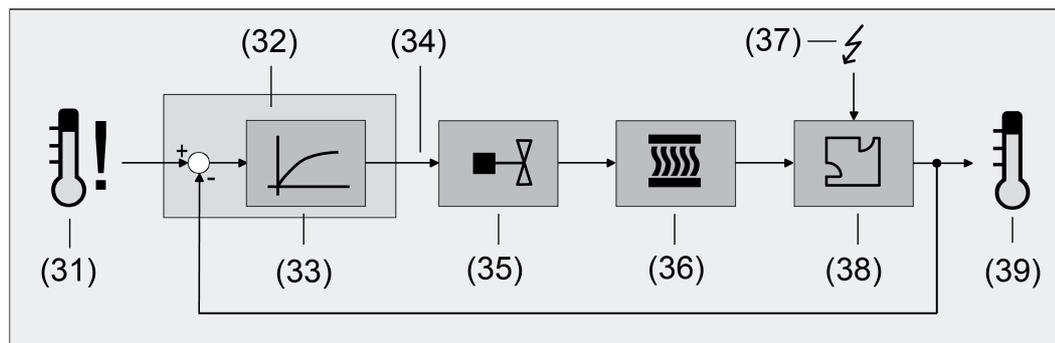
Bild 42: Regelstrecke einer Einzelraum-Temperaturregelung
