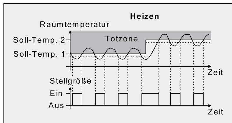
Bild 47: 2-Punkt-Regelung für Mischbetriebsart "Heizen und Kühlen" bei aktivem Heizbetrieb
