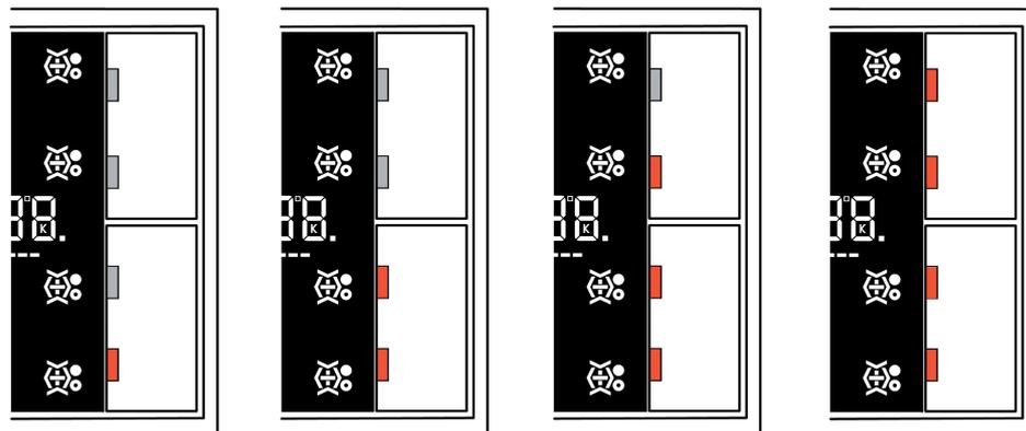
Bild 73: Standard Anzeigefunktion: positive Sollwertverschiebung "4 Schritte"
