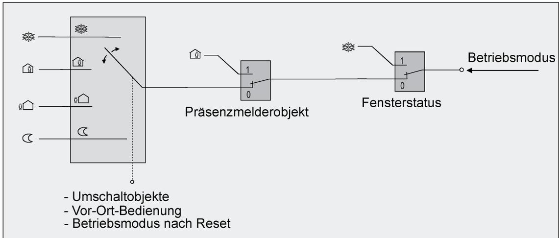
Bild 52: Betriebsmodusumschaltung durch 4 x 1 Bit Objekte mit Präsenzmelder
