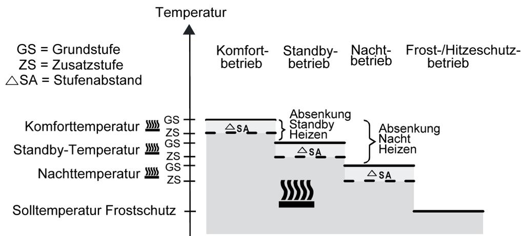
Bild 56: Solltemperaturen in der Betriebsart "Grund- und Zusatzheizen"
