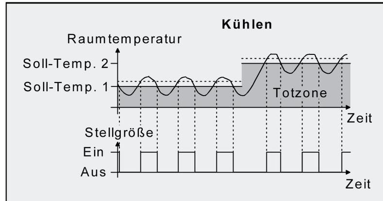
Bild 48: 2-Punkt-Regelung für Mischbetriebsart "Heizen und Kühlen" bei aktivem Kühlbetrieb
