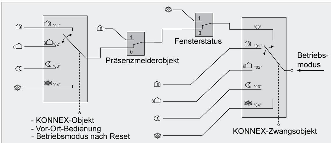
Bild 54: Betriebsmodusumschaltung durch KONNEX Objekt mit Präsenzmelder
