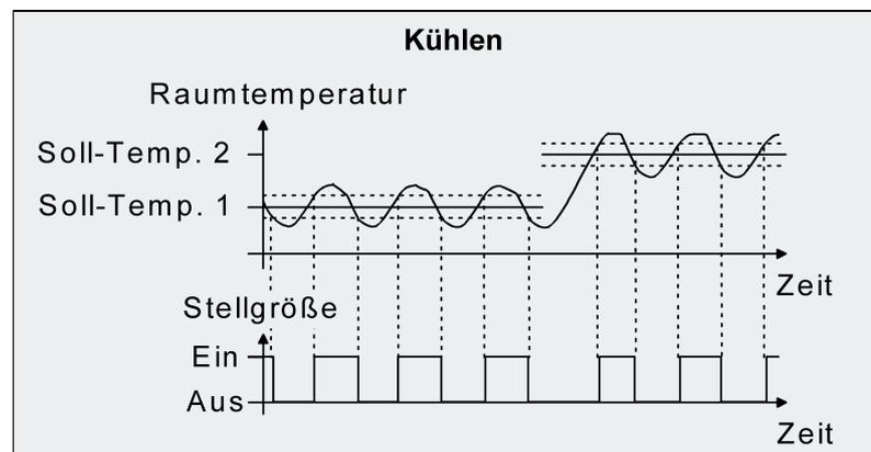
Bild 46: 2-Punkt-Regelung für Einzelbetriebsart "Kühlen"
