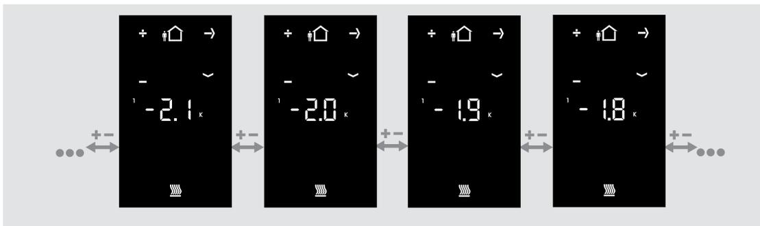
Bild 21: Einstellen der Solltemperatur Absenkung für Standbymodus Heizen
