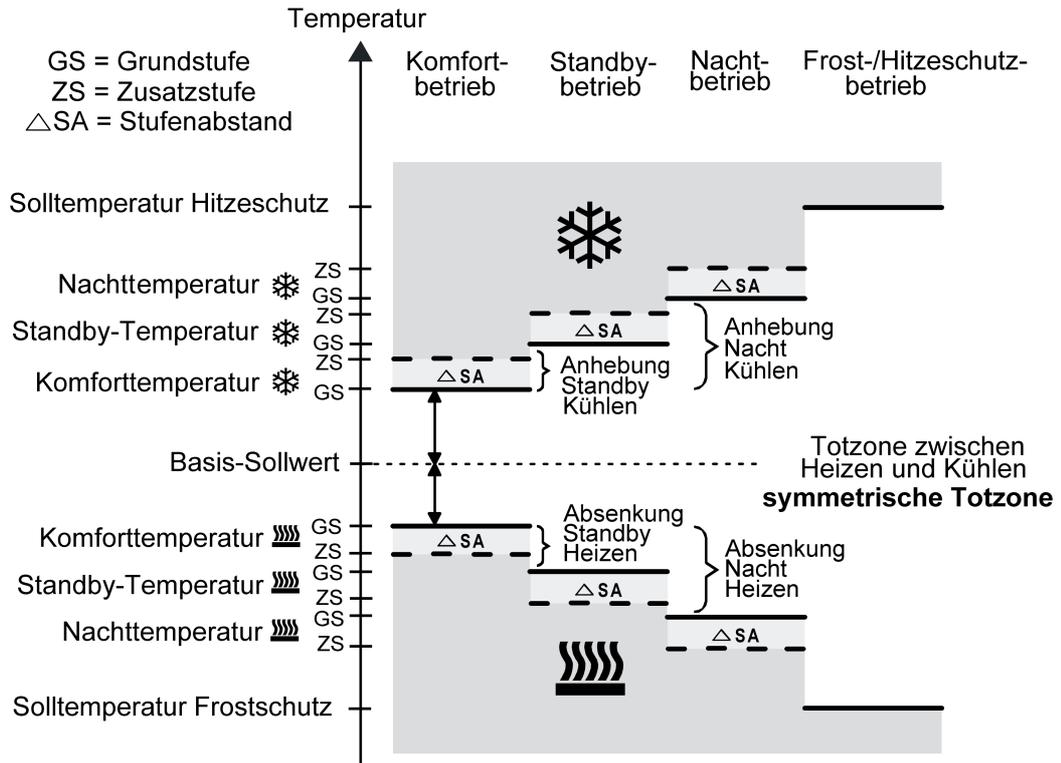
Bild 61: Solltemperaturen in der Betriebsart "Grund- und Zusatzheizen und -kühlen" mit symmetrischer Totzone
