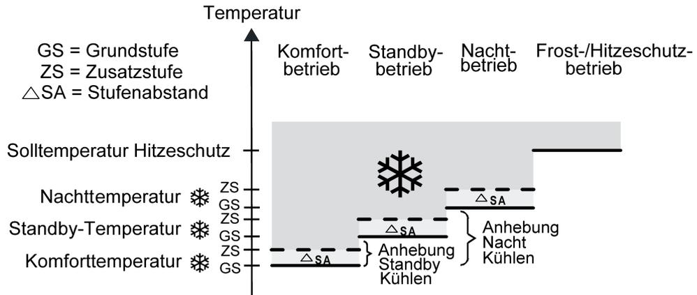
Bild 58: Solltemperaturen in der Betriebsart "Grund- und Zusatzkühlen"
