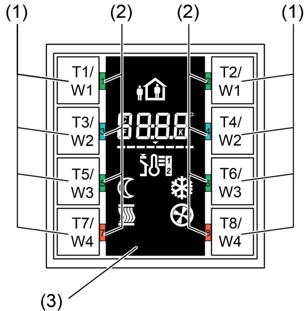
Bild 3: Frontansicht Kompakt-Raumcontroller-Modul 4fach
