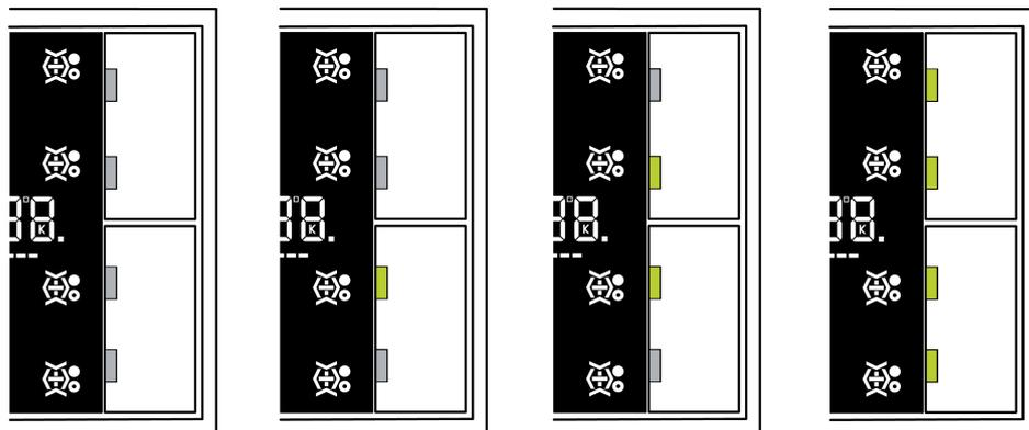
Bild 75: Standard Anzeigefunktion: Anzeige Sollwertverschiebung "Keine Verstellung"
