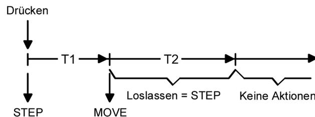
Bild 64: Bedienkonzept "Kurz-Lang-Kurz"
