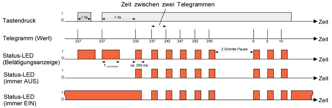
Bild 69: Beispiel zur Wertverstellung mit Wertbereichs-Überlauf
