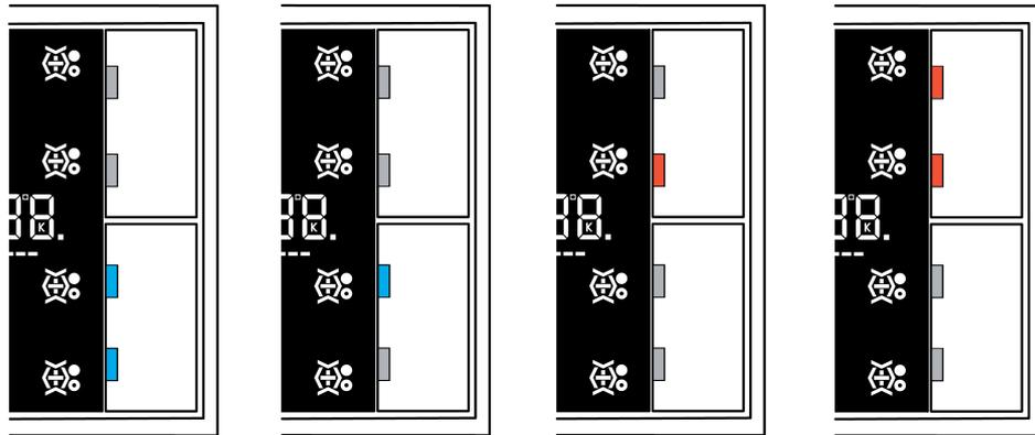
Bild 74: Standard Anzeigefunktion: Anzeige Sollwertverschiebung "2 Schritte"
