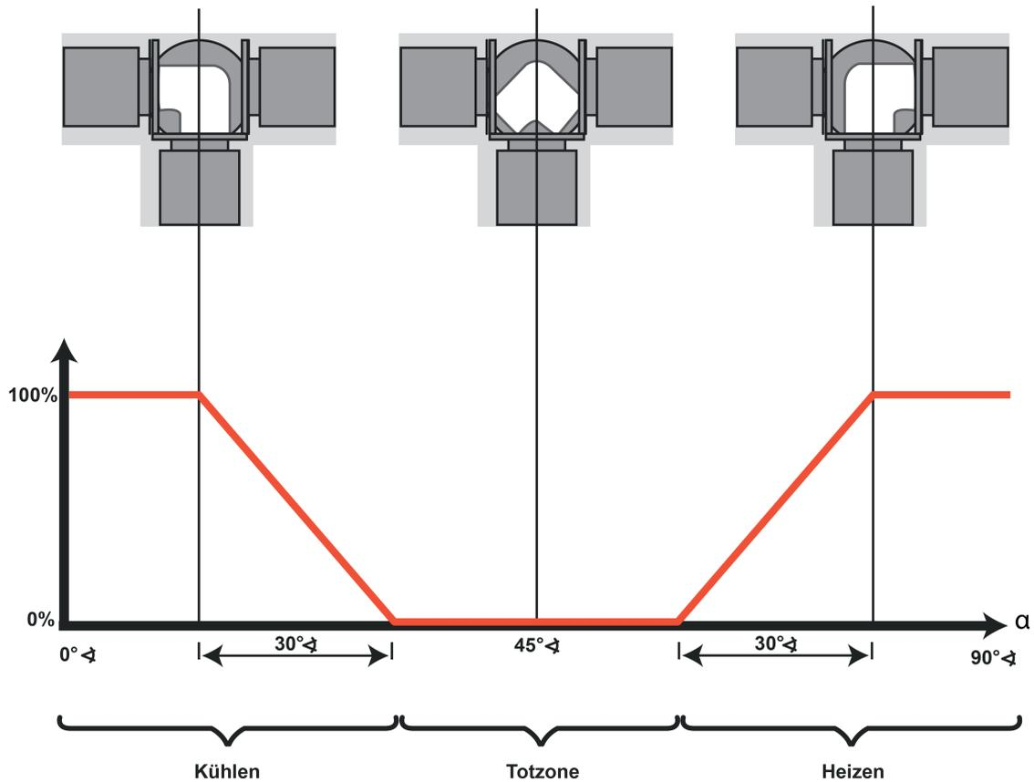
Bild 63: Regelkugelhahn - Ventilkennlinie
