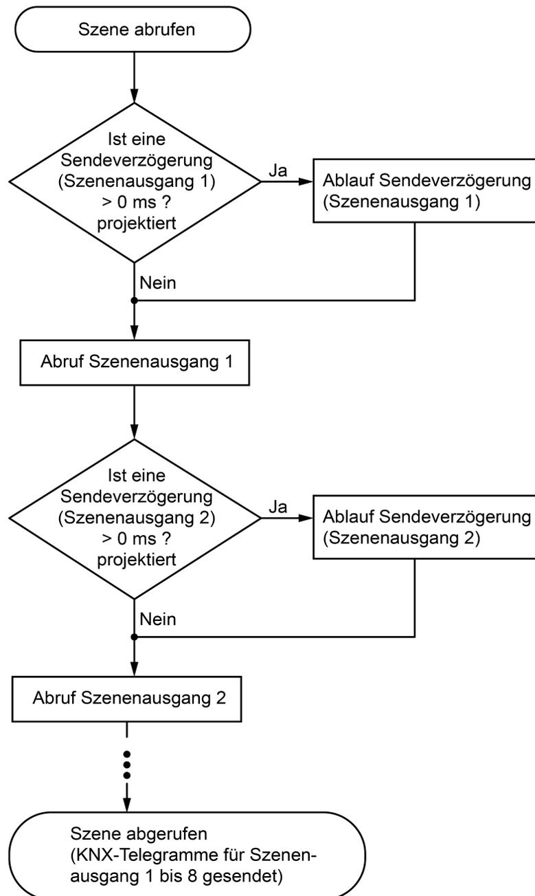
Bild 76: Flussdiagramm zur Sendeverzögerung einen Szenenausgangs
