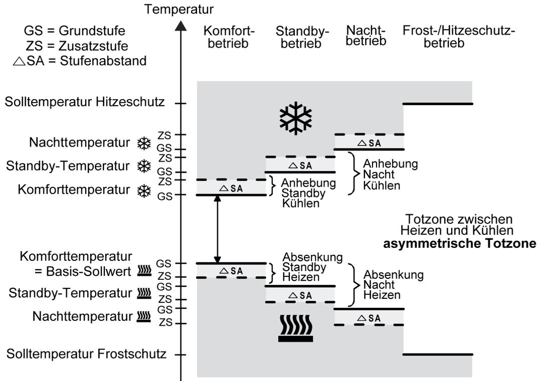
Bild 62: Solltemperaturen in der Betriebsart "Grund- und Zusatzheizen und -kühlen" mit asymmetrischer Totzone
