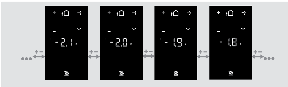
Bild 21: Einstellen der Solltemperatur Absenkung für Standbymodus Heizen
