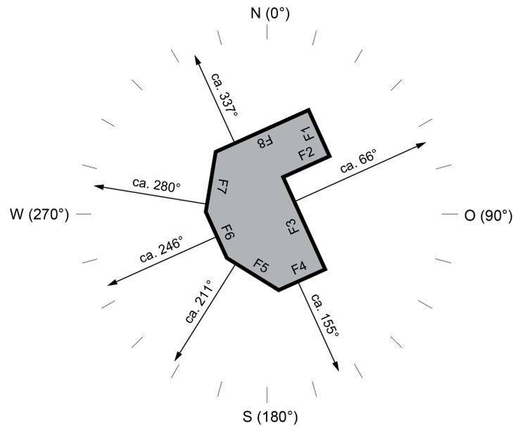
Bild 19: Fassadenausrichtung eines Gebäudes mit 8 Fassaden
