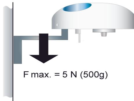
Bild 6: Maximale Belastung am Befestigungsarm der Wetterstation
