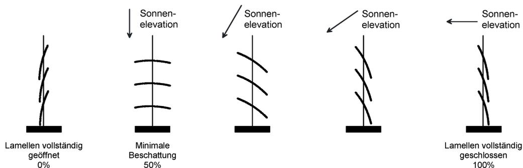
Bild 20: Lamellen werden abhängig vom Sonnenstand positioniert
