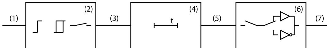
Bild 28: Blockdiagramm Ein- und Ausschaltverzögerung
