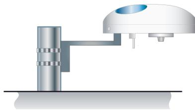
Bild 4: Montage der Wetterstation an einem Mast
