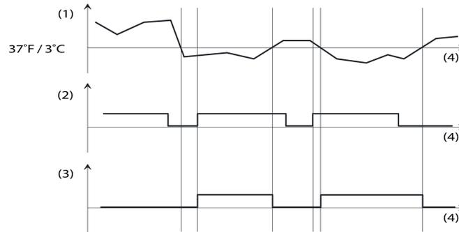
Bild 11: Vereisungsschutz in Abhängigkeit von Temperatur und Niederschlag
