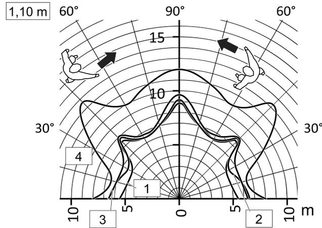
Bild 11: Reichweite bei tangentialer Bewegungsrichtung, Einbauhöhe 1,10 m
