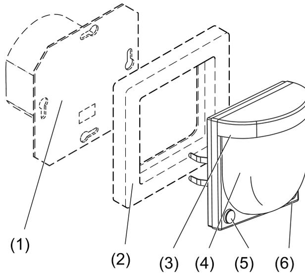
Bild 1: Geräteaufbau
