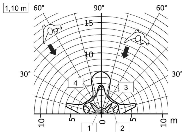
Bild 12: Reichweite bei radialer Bewegungsrichtung, Einbauhöhe 1,10 m
