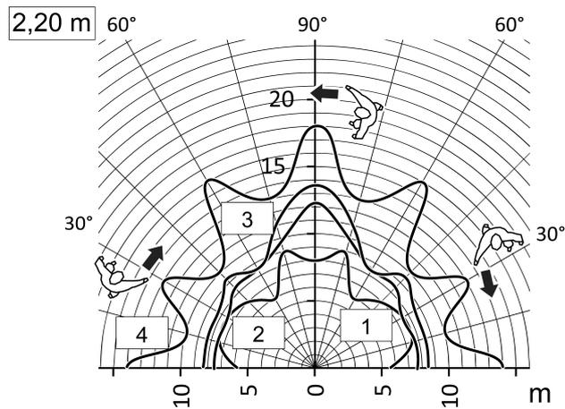
Bild 9: Reichweite bei tangentialer Bewegungsrichtung, Einbauhöhe 2,20 m
