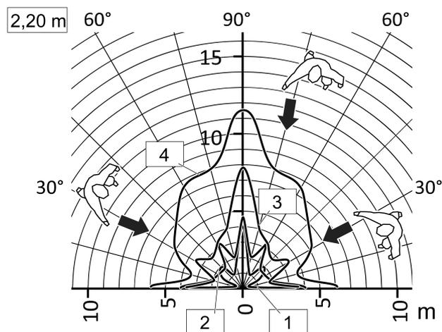
Bild 10: Reichweite bei radialer Bewegungsrichtung, Einbauhöhe 2,20 m
