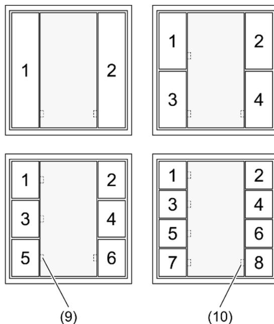
Bild 2: Tastenbelegung Wandsender-Modul 1fach, 2fach, 3fach und 4fach
