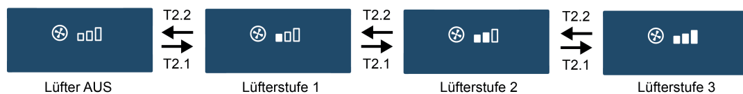
Bild 8: Einstellung der manuellen Lüftersteuerung (Bedienebene)
