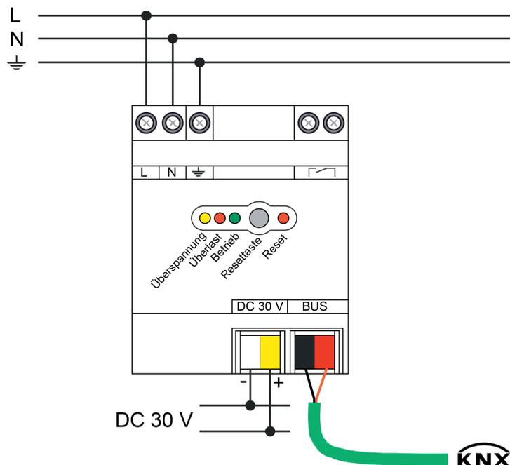
Bild 2: Geräteanschluss (Anschlussbeispiel)
