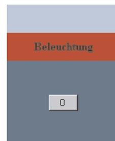
Bei deaktiviertem **S und A-Flag** wird ebenfalls kein Status angezeigt und zusätzlich die 1 Taste ausgeblendet. z.B. für Zentral Aus.
