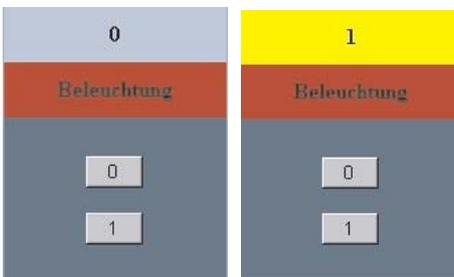
Diese Ansicht zeigt den Taster für 1Bit Befehle mit allen Flags. Die Kontrollanzeige wechselt entsprechend dem Schaltzustand, der über die Tasten 1 + 0 gesendet wird.
