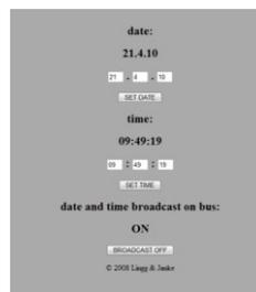
Die NK-FW dienen auch als Zeitgeber für alle am Bus angeschlossenen **FacilityWeb** Geräte. Datum und Uhrzeit können manuell per Webbrowser eingestellt werden (NK-FW-clock zusätzlich batteriegepuffert) oder das am Bus vorhandene Zeitsignal wird verwendet und an die FW-Geräte weitergeleitet.
