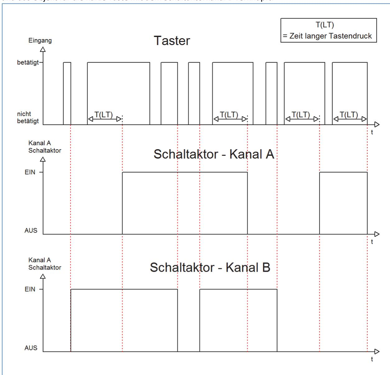
Der Taster schaltet in diesem Beispiel durch den kurzen Tastendruck den Kanal B. Bei jeder Betätigung wird der Kanal umgeschaltet, d.h. sein aktueller Zustand wechselt bei jeder Betätigung. Die Betätigung der kurzen Taste hat keinerlei Bedeutung für den Kanal A. Dieser reagiert lediglich auf den langen Tastendruck mit einer Umschaltung:
