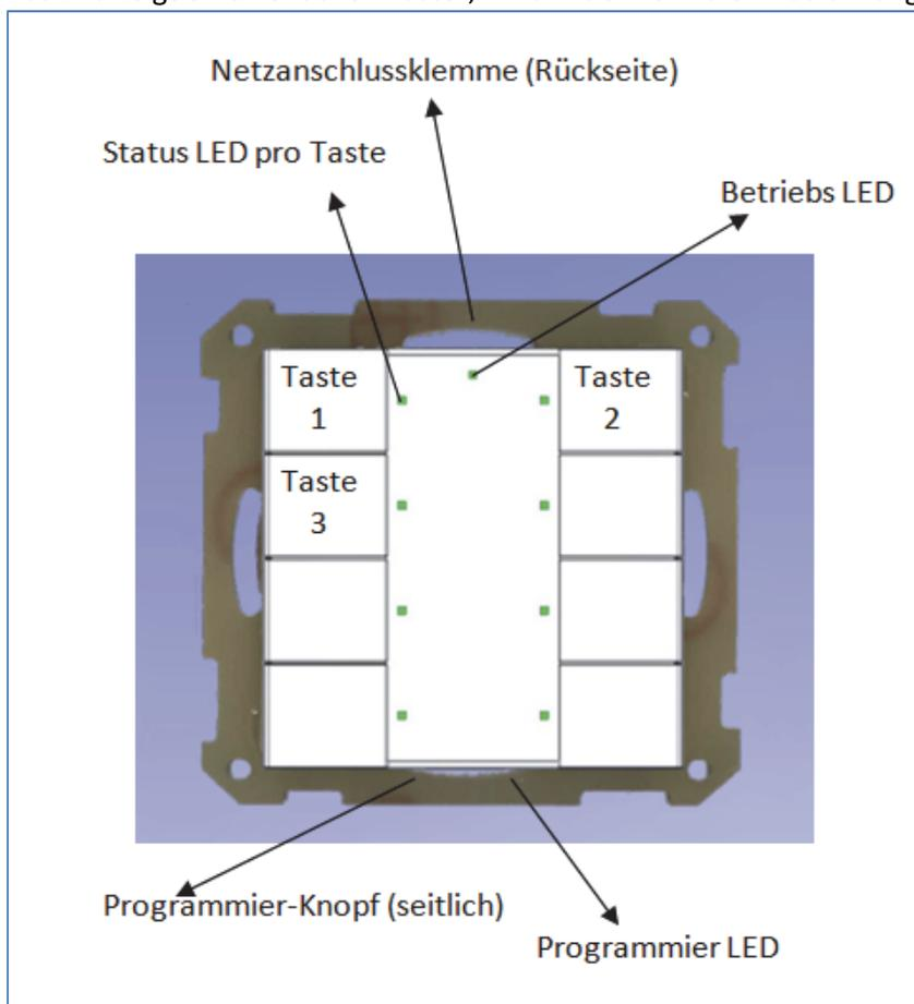
Abbildung 3: Übersicht Hardwaremodul Taster
