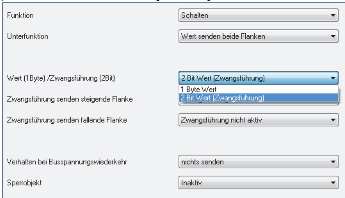
Abbildung 11: Unterfunktion Wert senden
