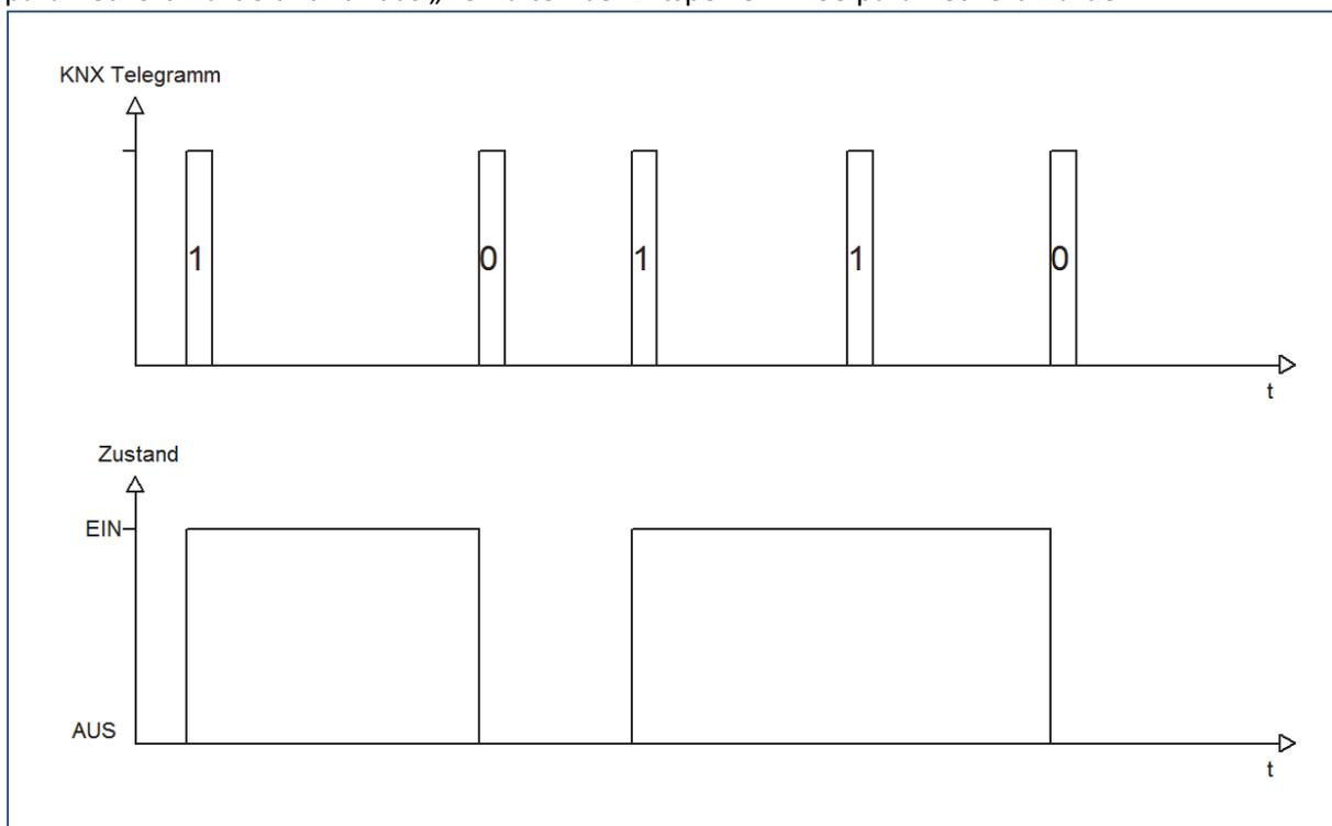
Das KNX-Telegramm zeigt, welche Wert dem Sperrobject gesendet wurden. Auf die Aktivierung (=Sendung einer logischen „1“) reagiert der dazugehörige Kanal mit dem Einschalten dieses Kanals. Wird der Sperrvorgang deaktiviert (=Sendung einer logischen „0“) so wird der dazugehörige Kanal wieder ausgeschaltet.
