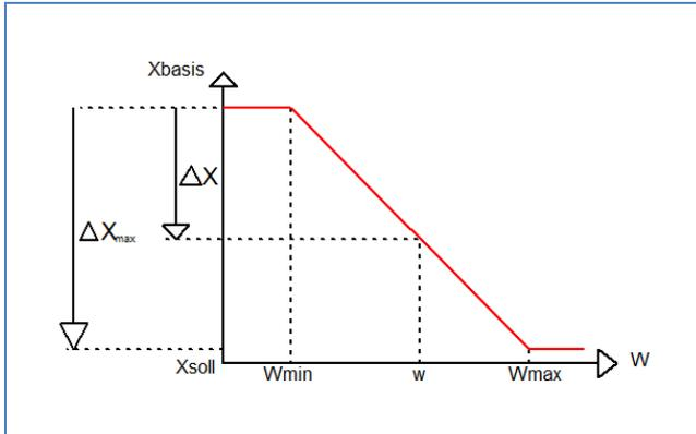
Abbildung 20: Beispiel – Führung Absenkung
