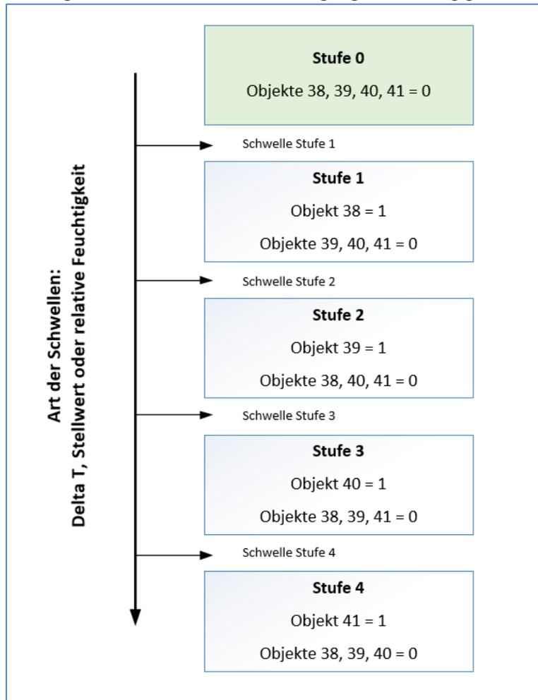
Abbildung 34: Schaltverhalten – Stufenschalter
