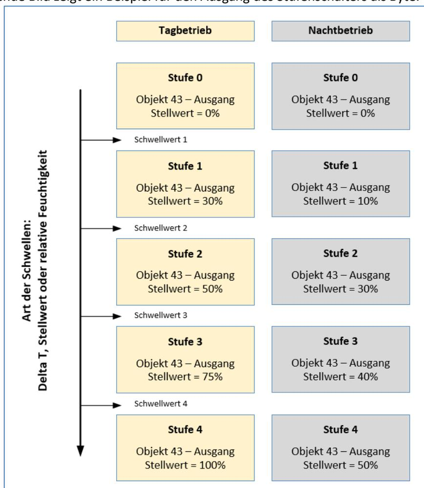
Abbildung 39: Beispiel Ausgang – Stufenschalter als Byte
