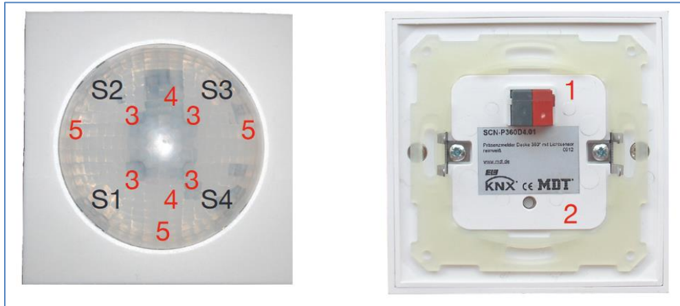
Abbildung 2: Aufbau und Anordnung der Sensoren/Leuchtdioden – SCN-P360x4.03
