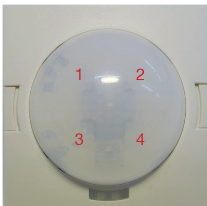
Bild 7: Nummerierung PIR Sensoren
