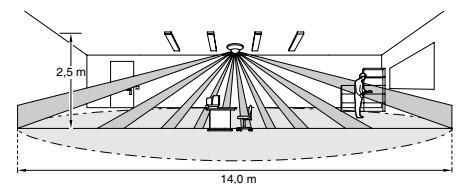
Bei einer gehenden Person ist ein größerer Erfassungsbereich vorhanden. Die Bezugsebene für die Erfassung ist der Fußboden.
