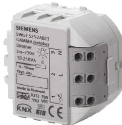
Der RS 525/23 Universaldimmer (RS Modul) ist ein KNX Gerät mit einem Dimmerausgang. Es wird in einem AP 118 Automationsmodulbox oder in der AP 641 Raumautomationsbox installiert. Der Busanschluss erfolgt über eine Busklemme, die Stromversorgung der Aktorelektronik über die Busspannung.
